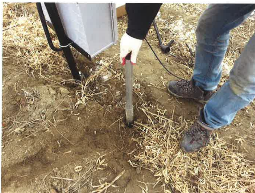
[그림 5.130] 합체 설치 및 토양함수비 센서 연결
