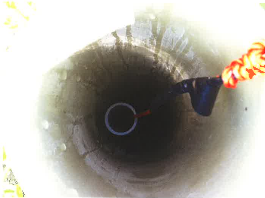
[그림 5.68] 지하수위 관측공 보호 및 수위계 설치 II
