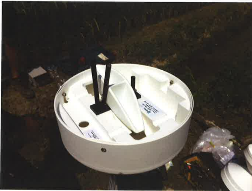
[그림 5.73] 강우량계 내부 tipping bucket
