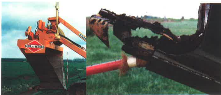
[그림 3.30] V형 쟁기날 방식의 흡수거 매설장치
