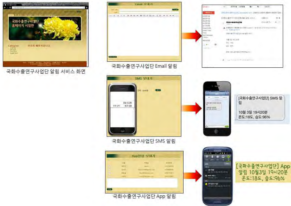
그림 3.1-3. 실시간 온습도 측정을 통한 이상 상태 알리기 시스템 프로토타입
