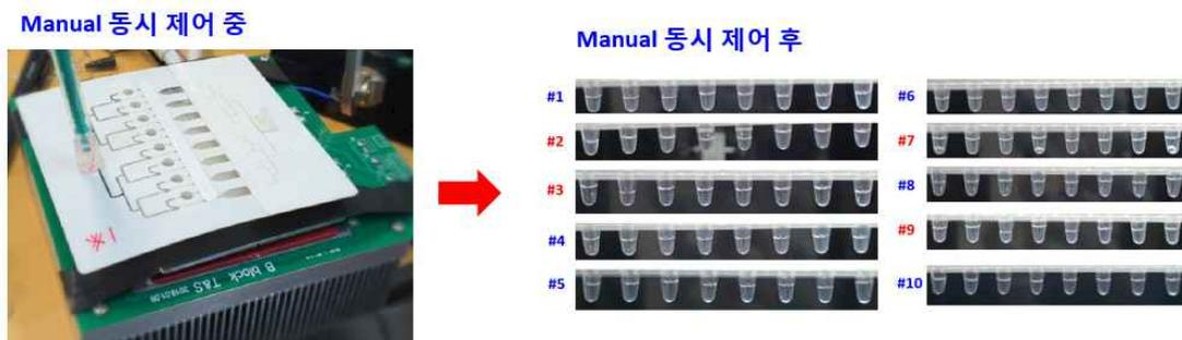
그림 75 Manual 동시 제어 Chip 재현성 Test
