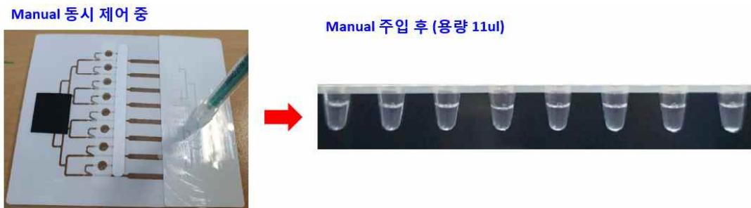
그림 77 Channel Design 수정 후 보완 적용 Test 결과
