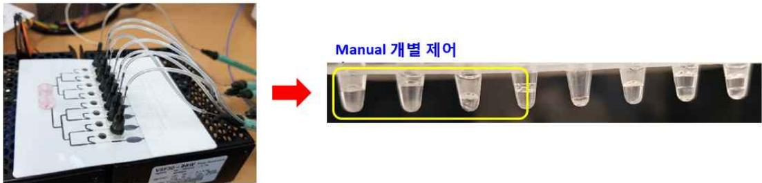
그림 72 Outlet의 개별 제어를 이용한 분주 Test
