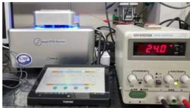
그림 44 칩의 증발 테스트 셋업
