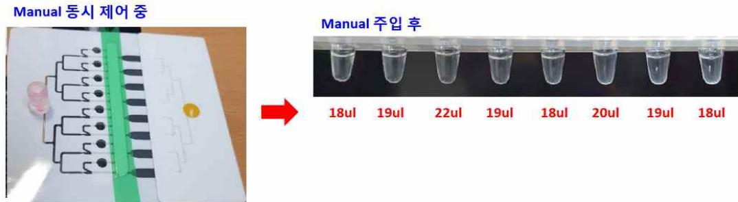
그림 80 Channel에 대한 용량 체크 확인 결과
