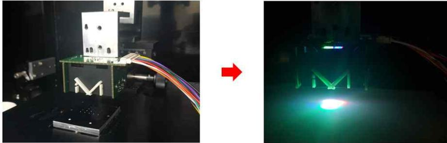
그림 90 SMPS 및 광학 모듈 Test Bed에 장착함으로 구동 확인 및 형광 측정 진행
