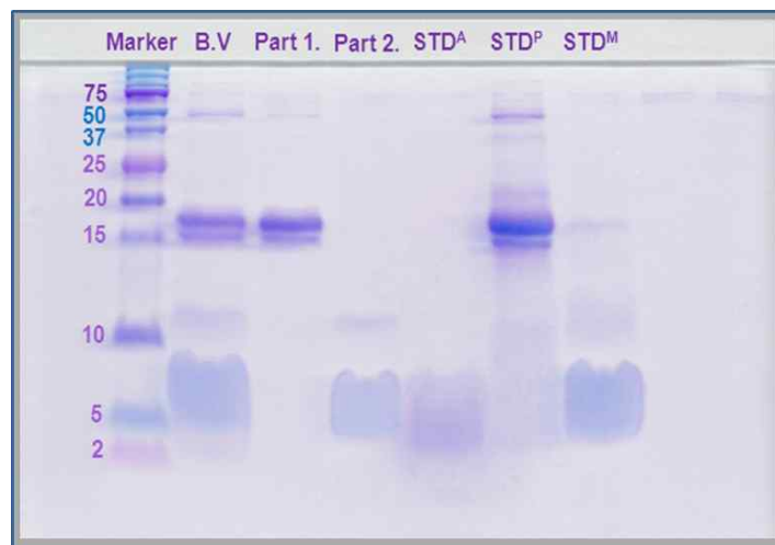
<그림 5. 분리된 정제봉독의 SDS-PAGE 결과>
