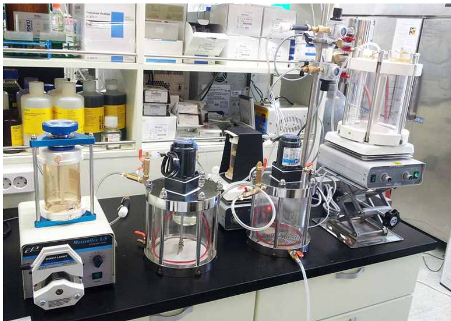
<그림 13. 분리-정제봉독의 대량생산 공정도 및 ultra filtration system>
