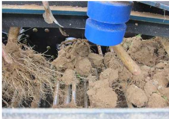
그림. 104 흙털림 불량 발생 모습
