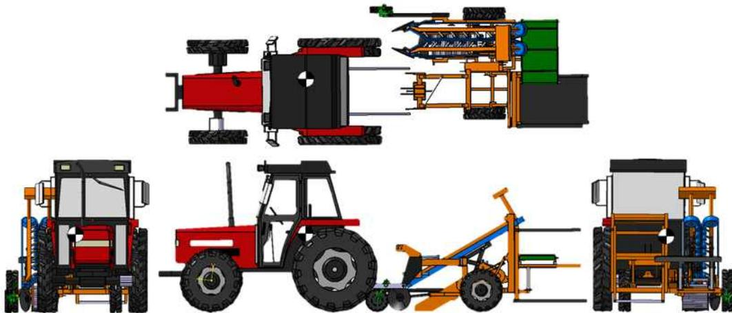
그림. 142 트랙터-수확기 시스템의 3D 모델링
