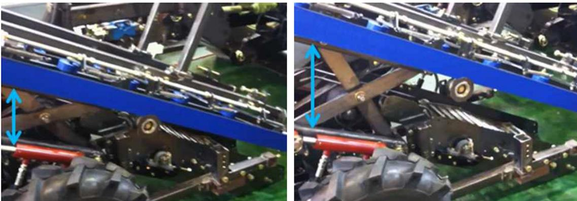
그림. 79 롤러 컨베이어 상하리프트 시스템
