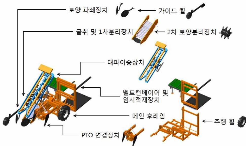
그림. 149 대파수확기 시스템 구성도
