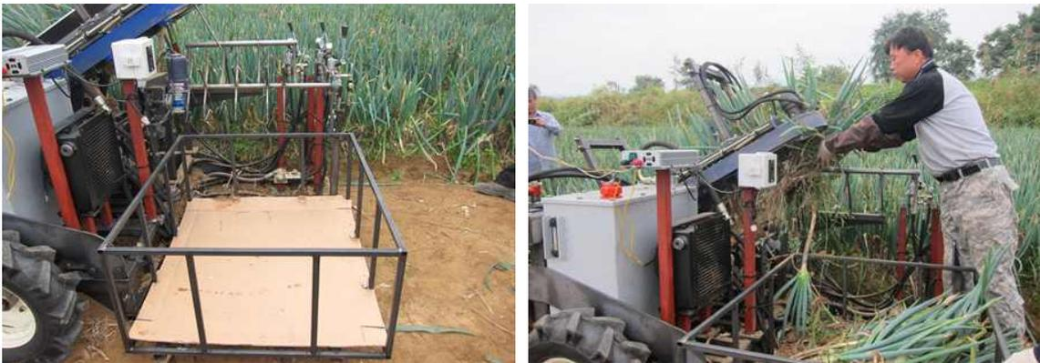
그림. 114 대과수확기 수집부 및 시험 방법
