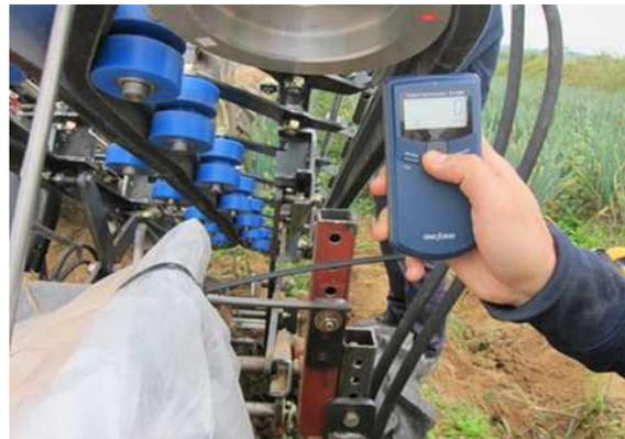
그림. 100 타코미터 외형 및 측정 모습
