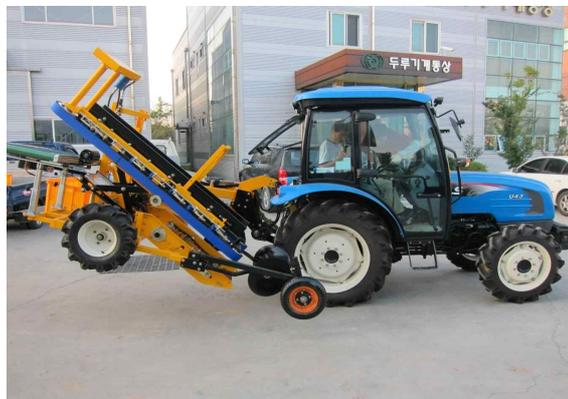
그림. 161 통합기 무부하 작동시험
