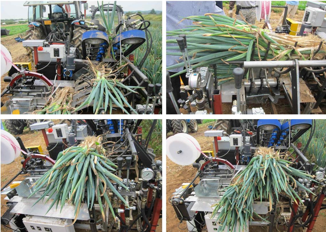
그림. 111 배출 및 결속부까지 이송장치 작업과정
