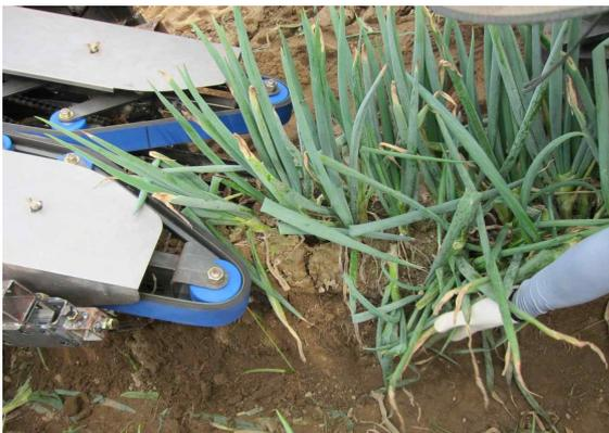
그림. 43 롤러 컨베이어 이송장치 시험 1
