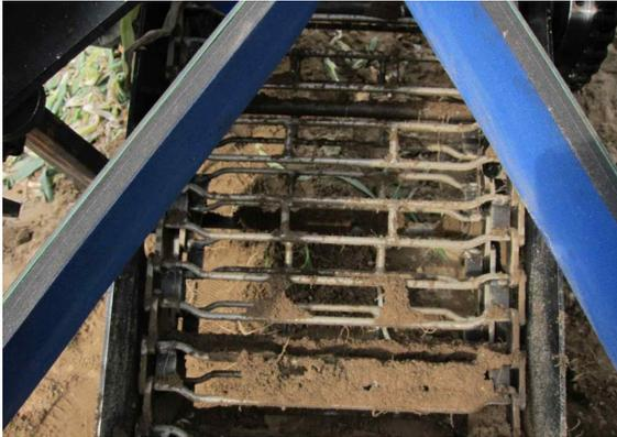
그림. 41 토양 분리장치 시험 1
