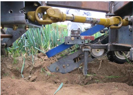
그림. 39 대파 굴취장치 시험 1
