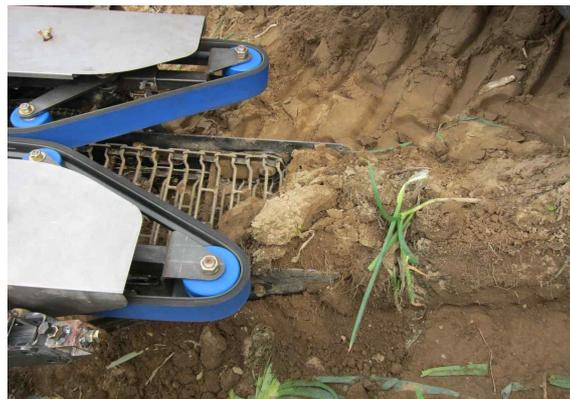
그림. 40 대파 굴취장치 시험 2
