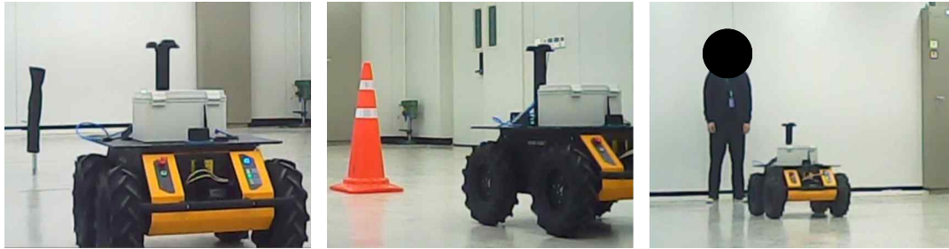
< 3종 정지 장애물 대상 충돌방지 시험: 폭좁은 장애물, 라바콘, 사람 >
