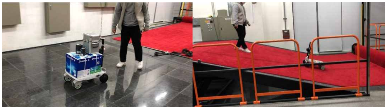
제어기 성능 테스트 (물류 적재 후 구동/등반능력)
