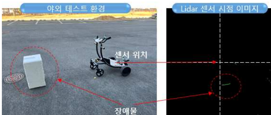
< 실외 정지/이동 장애물 테스트 환경 및 Lidar 시점 영상 >
