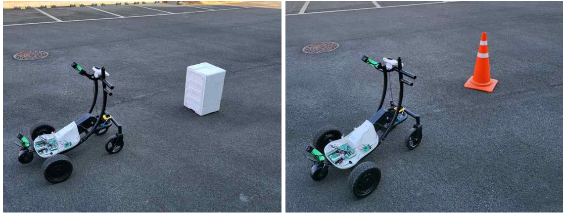
< 2종 정지 장애물 대상 충돌회피 시험: 박스, 라바콘 >
