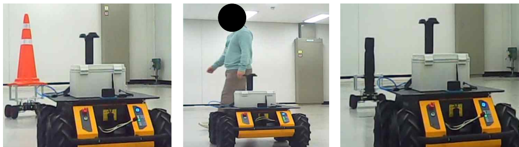
< 3종 이동 장애물 대상 충돌방지 시험: 이동 장애물 및 움직이는 사람 >
