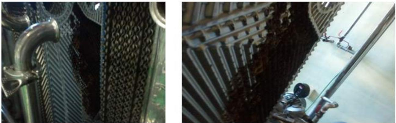
그림 1-47. 스케일 발생한 UHT 살균기 Plate
