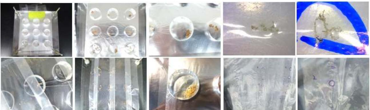
그림 13. 기피물질 처리 각 포장소재에서의 화랑곡나방 유충 천공 실험 결과
