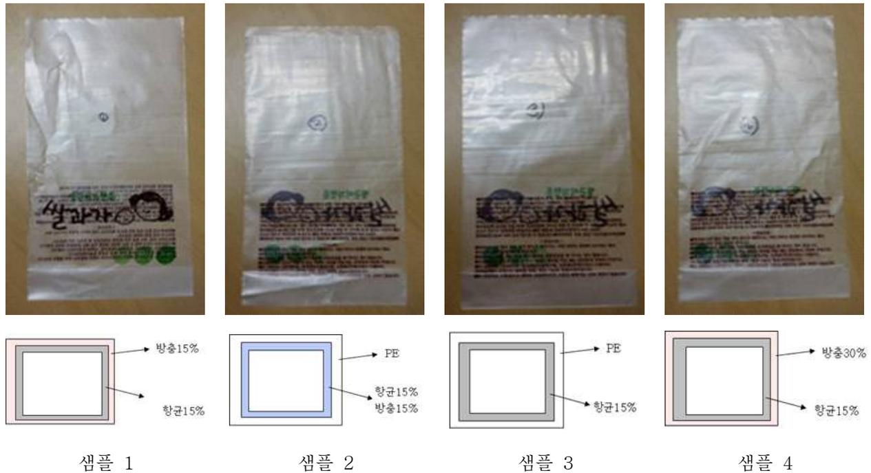
그림 8. 최종 제작한 방충/항균 필름 적용 식품 포장봉투 사진 및 구조도
