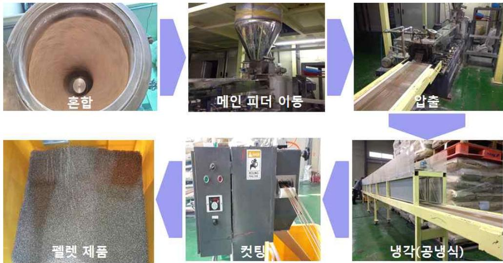
그림 4. 향균 및 방충 마스터배치 제작 과정
