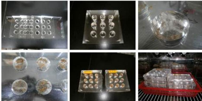
그림 4. 화랑곡나방 유충의 천공능력 시험
