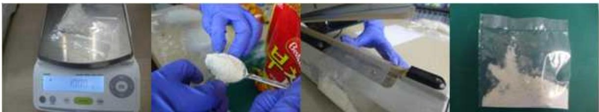
그림 7. 다층포장소재 필름을 이용한 기피효과 분석을 위한 봉투 제작
