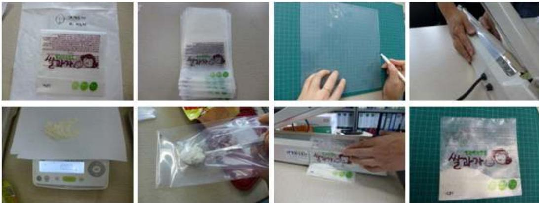
그림 13. 최종 시제품 포장소재의 기피효과 분석을 위한 실험봉투 제작
