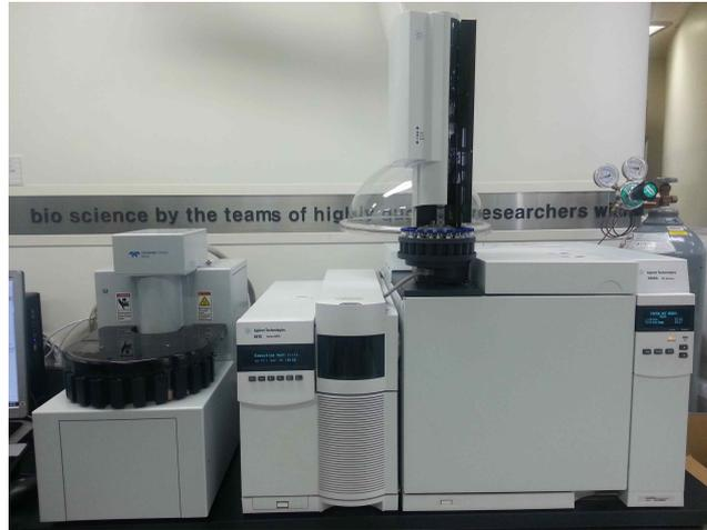
그림 18. Headspace & GC-MS System
