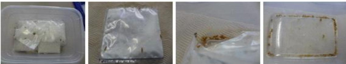
그림9. 다층포장소재 필름 이용 실험봉투에서의 화랑곡나방과 곡식수시렁이 기피효과 결과
