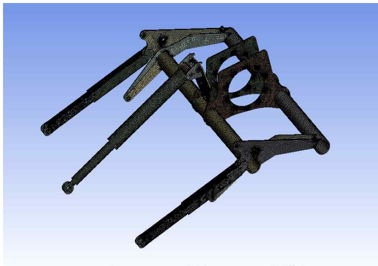
[ANSYS 시뮬레이션 모델 Mesh 진행 모델]
