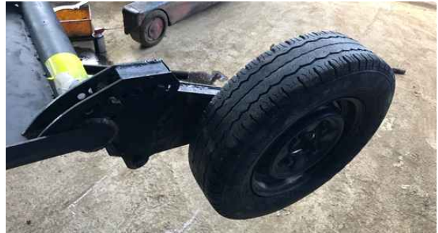
[수평조절기능을 위한 테스트 진행(바퀴장착)]
