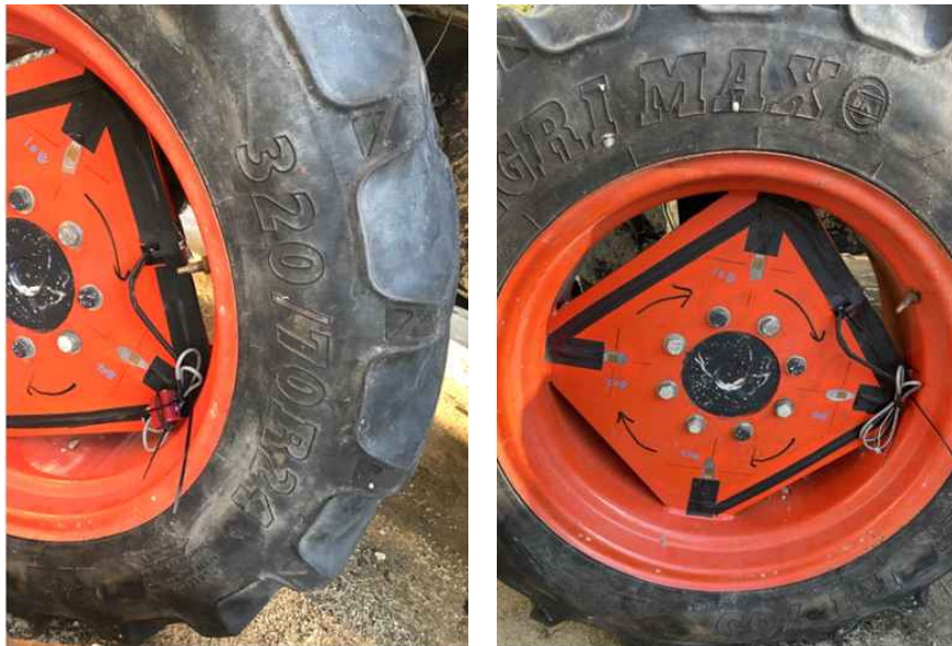
[전방 차축 Strain-gage 부착 사진]
