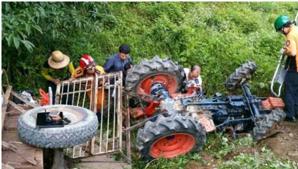
[복합작업기 장착에 의한 무게중심 변화에 따른 후방전복사고 유형]
