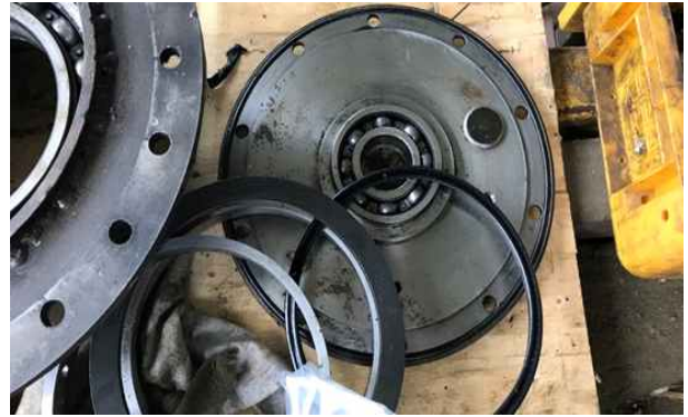
[오일링(셀) 불량으로 인한 오일부족, 과열 발생 구동축 기어 및 베어링 파손]
