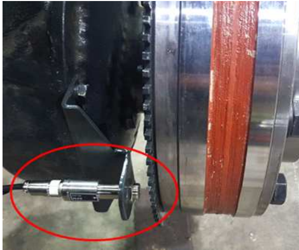
[전·후륜 근접 센서 부착 사진(좌/우)]
