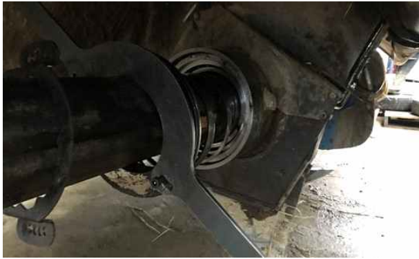
[오일링(셀) 불량으로 인한 오일부족, 과열 발생 구동축 기어 및 베어링 파손]
