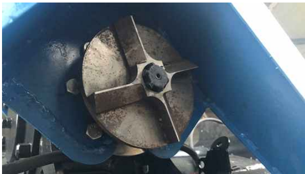
[복합작업기 연결방향 도그 클러치 제작 및 조립]
