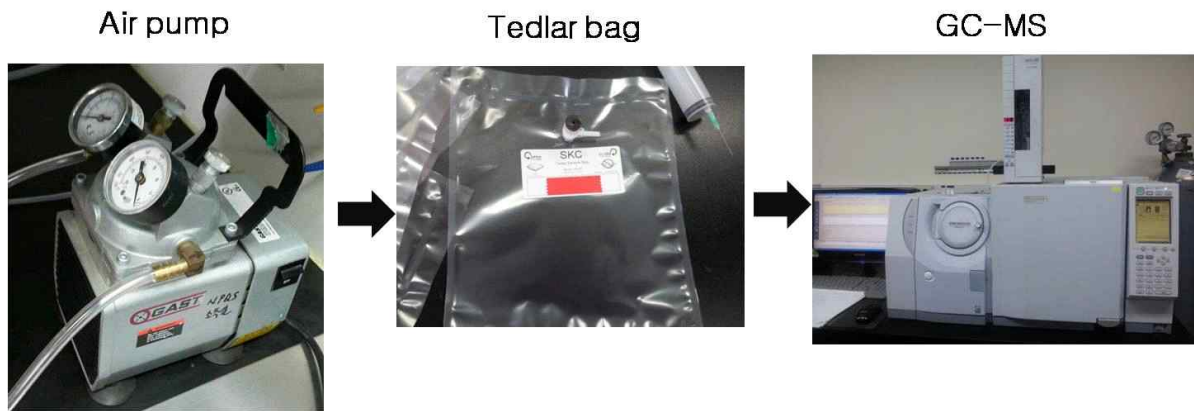
Fig. 13. 컨테이너 내부의 티몰 가스 포집 및 분석. 컨테이너 내부의 가스를 시간대 별로 에어 펌프를 이용해 tedlar bag에 포집함. 포집된 가스 샘플을 각각 40ml 씩 에틸아세테이트 용매 2ml에 직접 녹여 GC-MS 로 분석함.
