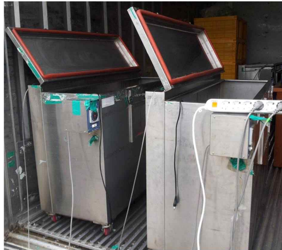
Fig.11. 식물 검역소의 500L (약 0.5톤; 가로125cm x 세로 50cm x 높이 80cm)의 내부에서 가스를 포집할 수 있는 훈증 실험용 컨테이너
