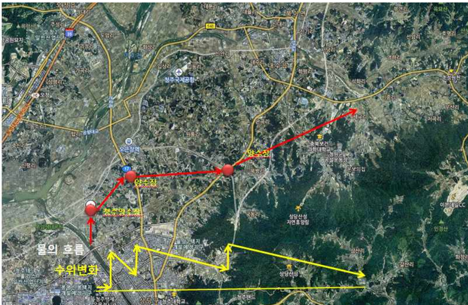
<그림 7-9> 양수장을 이용한 용수공급 형태
