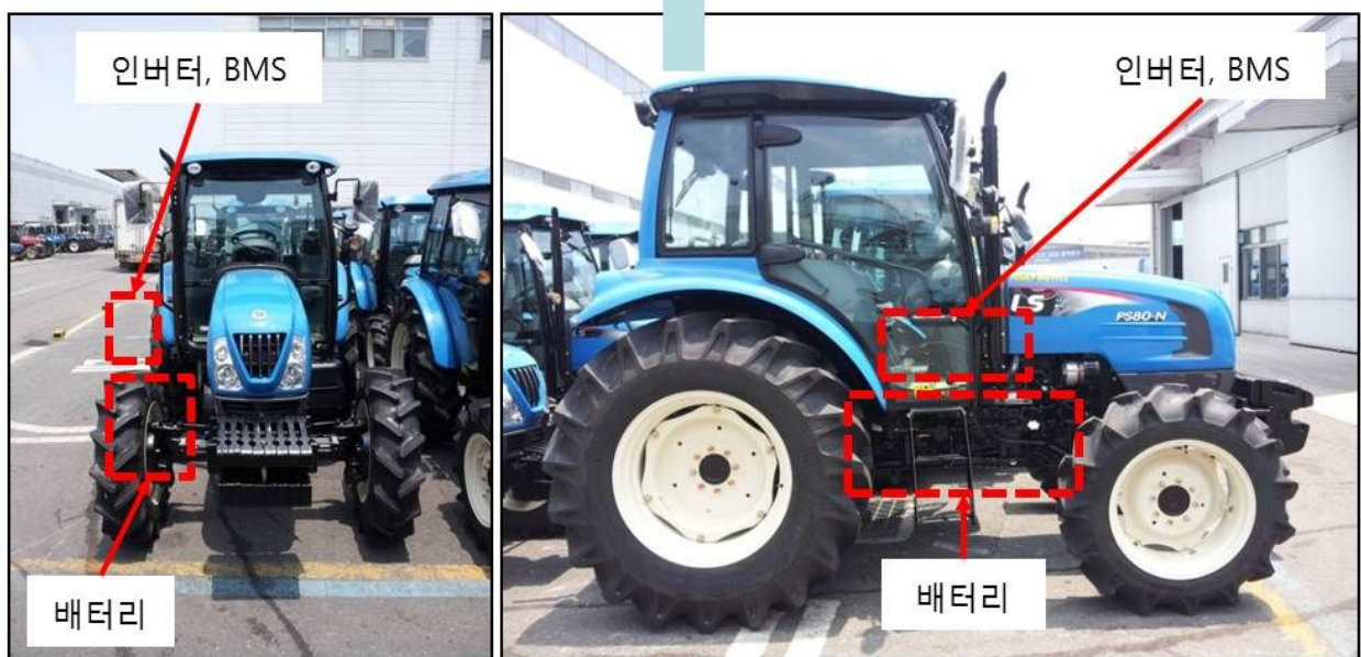
그림 1-117 하이브리드 트랙터 배터리 장착부.
