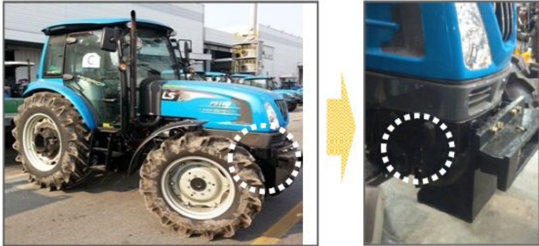
그림 1-87 하이브리드 트랙터 배터리 설치부.
