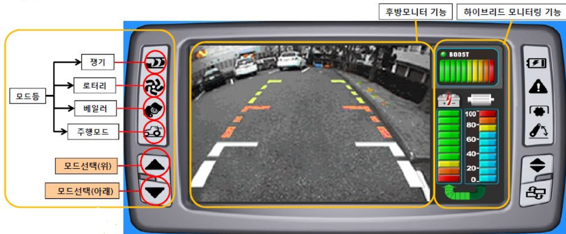
그림 1-90 하이브리드 시스템 모니터링 장치 구성(작업모드 선택기능).
