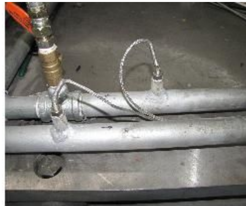
그림 1-11 냉각수의 온도측정을 위한 PRTD.
