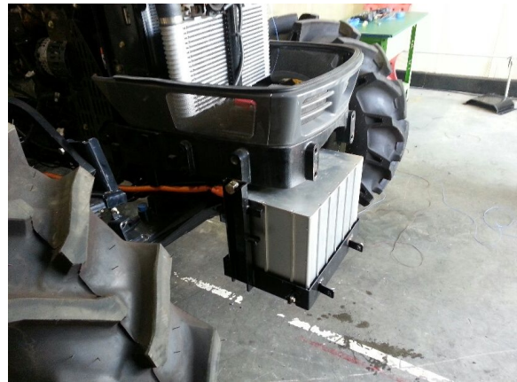
그림 1-62 하이브리드 트랙터 2차 시제품 전방 배터리팩 장착.
