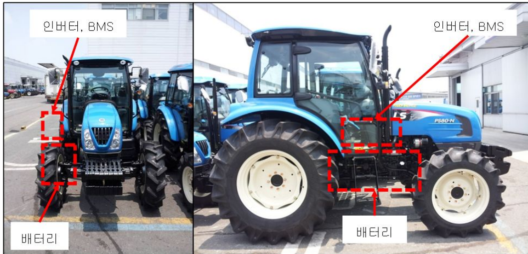
그림 1-56 인버터, 배터리-BMS 장착 부위.
