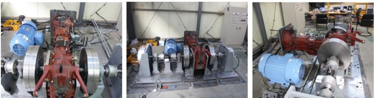
그림 1-5 하이브리드 트랙터 핵심부품의 내구 시험 장치.
