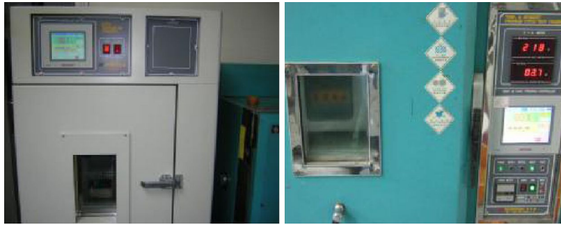
그림 1-38 온도시험 (좌)-30℃, (우)80℃.
