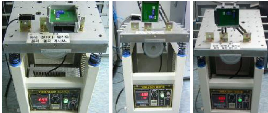
그림 1-36 내진성 시험(좌)전후, (중)상하, (우)좌우.
