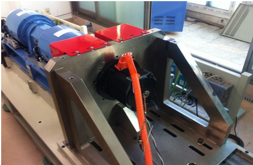
그림 2-40 인버터/컨버터의 모터구동 시험 환경.
