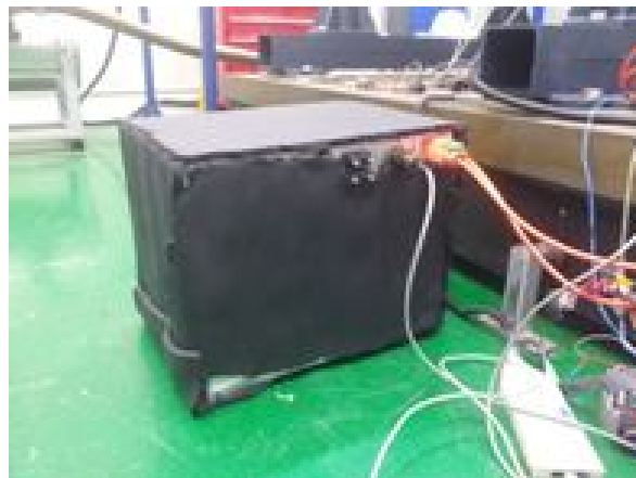
그림 2-69 배터리 팩 2차 시작품 발열 분석.
