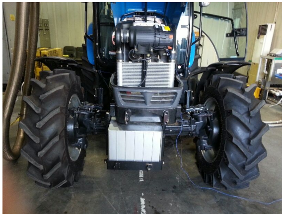
그림 1-62 하이브리드 트랙터 2차 시제품 전방 배터리팩 장착.
