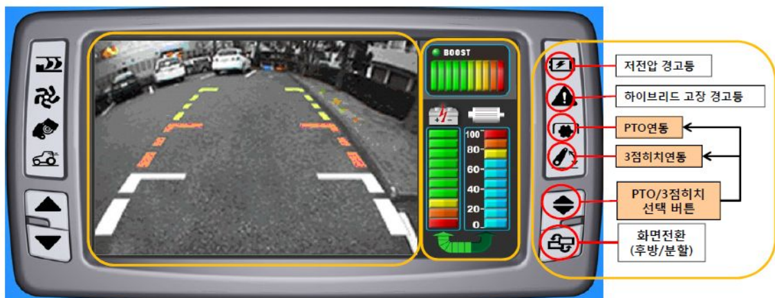
그림 1-91 하이브리드 시스템 모니터링 장치 구성(PTO / 3점히치 연동모드).
