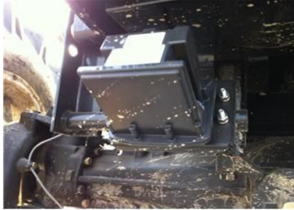
그림 1-106 트랙터 작업 속도 측정 센서.
