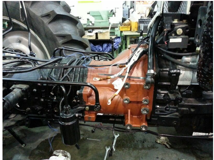
그림 1-59 하이브리드 트랙터 2차 시작품 모터-발전기 장착.
