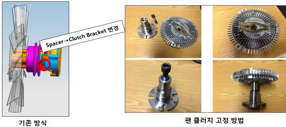
그림 1-72 팬-클러치 고정을 위한 설계변경.
