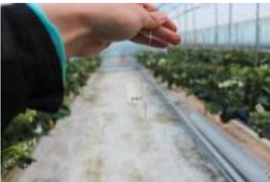
Fig. 2-31. 온실 2 내부온도 측정용 열전대(CH 16). Fig. 2-31. 팬코일 유닛 온수 공급부 열전대 (CH 17)
