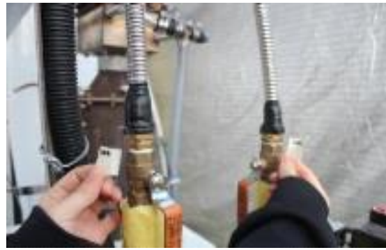
Fig. 2-24. 열교환기 입구부(CH4)와 출구부(CH5) 열전
