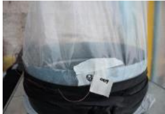
Fig. 2-33. 팬코일 유닛 덕트 온도 측정용 열전대(CH 19)
