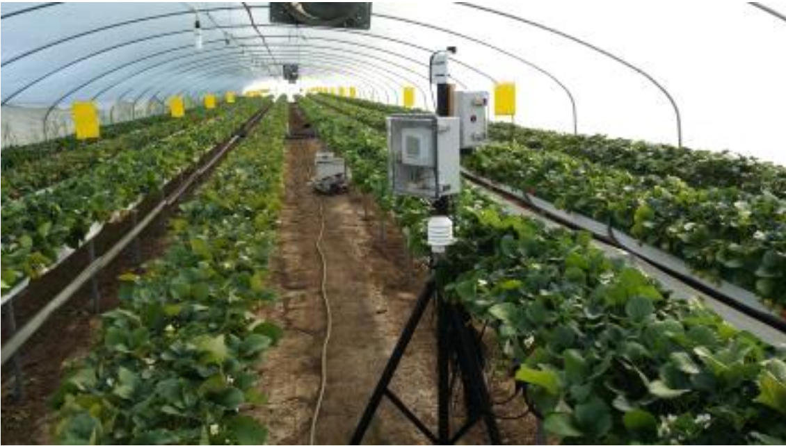
Fig. 3-41. 실험온실내 환경측정을 위한 Weather station 및 Data logger
