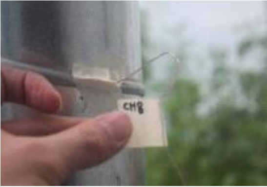
Fig. 2-27. 송풍기전 배관내 열전대(CH8).
