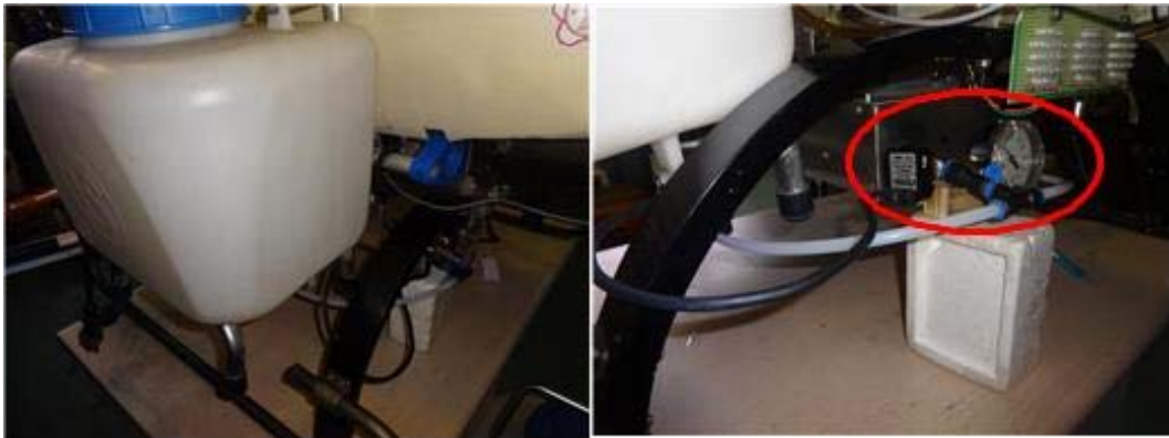
그림 6-18 무인 헬리콥터 살포장치의 약통과 펌프에 장착된 압력변환기와 게이지
