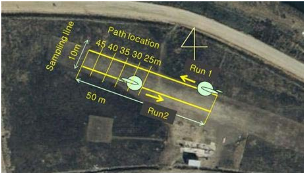
그림 7-16 변량제어 살포 패턴과 균일도를 측정하기 위한 금호강 둔치에 설치된 샘플링 레이아웃
