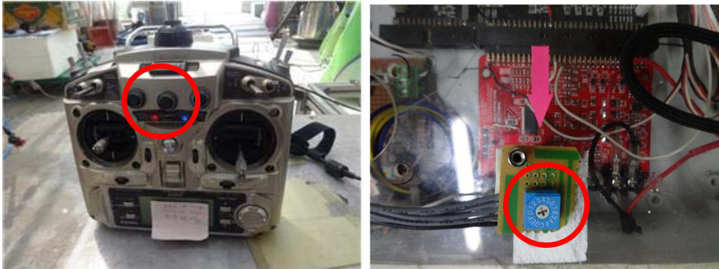
그림 7-3 변량제어 프로그램에 목표속도( V_0 )를 설정하기 위한 두 가지 방법 (a) 조종기의 VR 다이얼과 (b) 모터드라이브에 설치된 디지털 선택스위치.
