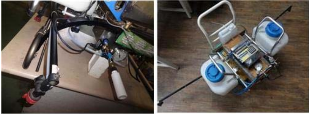
그림 6-21 펌프 출구 근처에 설치된 공기실과 장착된 측정 장치의 배치에
