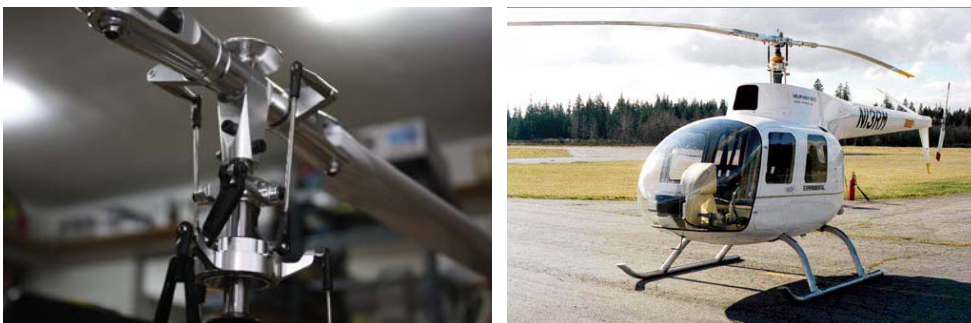
그림 3-1 운동역학적으로 응답성이 우수한 스테비바레스 스와시 헤드 형식
