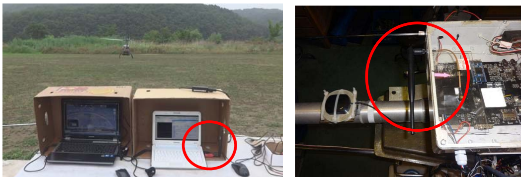
그림 5-11 지상 모니터링 시스템(GMS) 블루투스의 송 수신기 장착 모습
