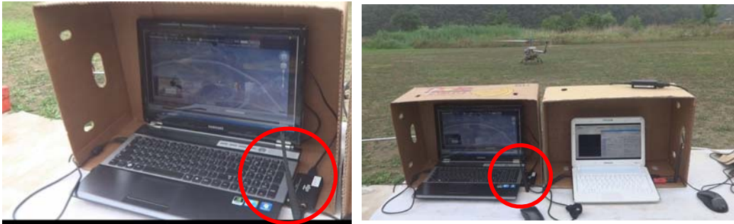
그림 4-9. 구간 비행안내 시스템(guidance waypoint system) and GCS(ground control station)의 송신 및 수신 통신모듈 (900MHz).
