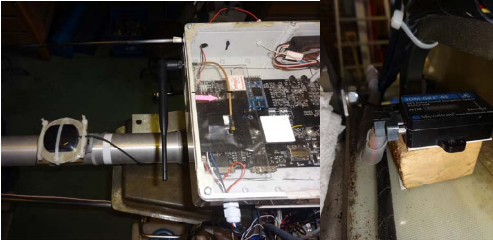
그림 6-2 헬리콥터 기체에 장착된 VRA 모듈 및 관성센서와 GPS의 장착위치
