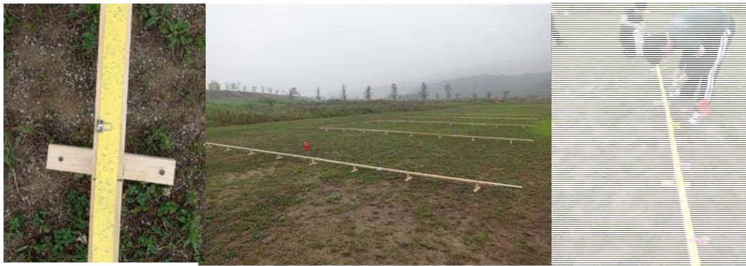
그림 7-23 길이 9m의 감수지 패턴 샘플링 거치대가 살포거리 5m 간격으로 설치되었고 매 살포 비행에서 90장의 50cm 길이 감수지 띠가 수집 보존되었다.
