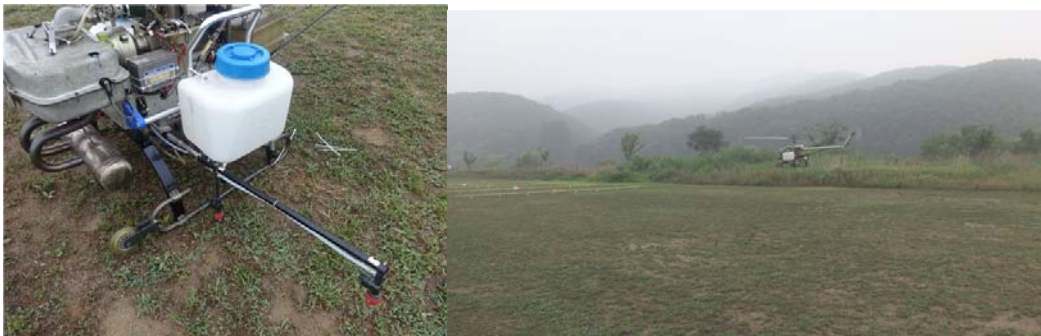
그림 7-14 변량살포 시스템의 살포패턴과 균일도 측정을 위한 테스트베드
