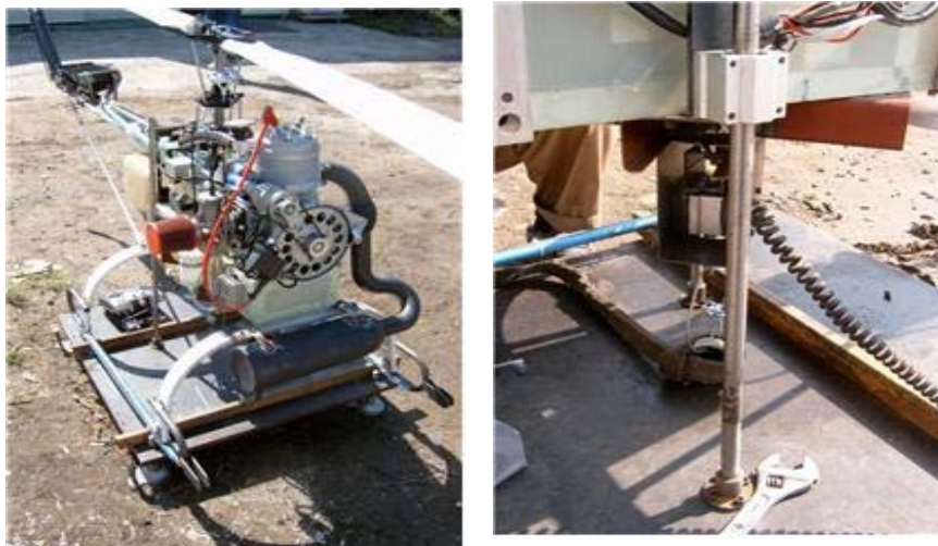
그림 3-25 개선된 동력부와 블레이드를 장착한 스테비바레스 농용 회전익기의 양력 시험
