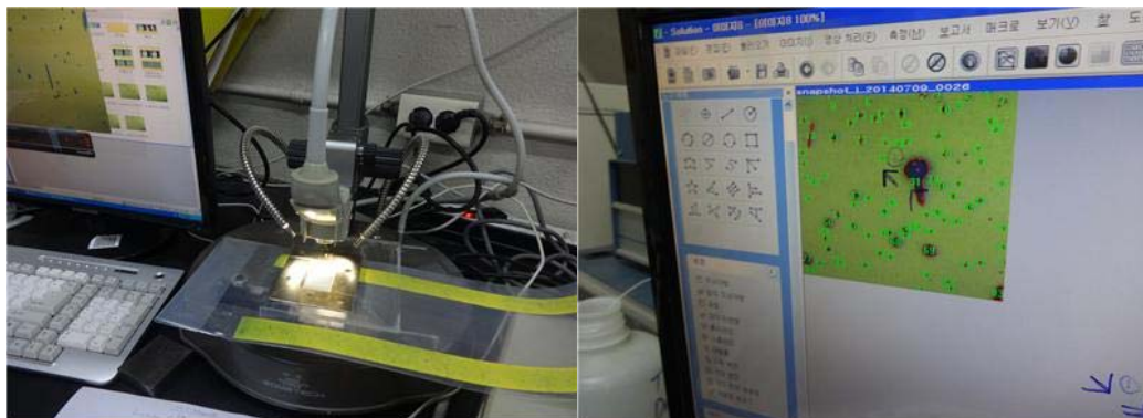
그림 7-24 이미지 입자 분석기(SV-35, Sometech, Inc.)와 분석프로그램(i-Solution)으로 단위면적에 남겨진 입자의 총갯수, 면적과 퍼센트를 분석하였다.
