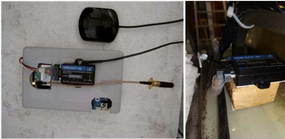
그림 5-7 변량살포(VRA)시스템의 모터제어를 위해 선택된 관성센서(IMU)와 GPS 그리고 무게중심 부근에 장착된 IMU
