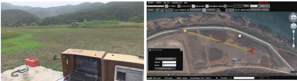
그림 7-8 금호강 둔치에서 행한 안내시스템(waypoint)을 이용한 살포 비행
