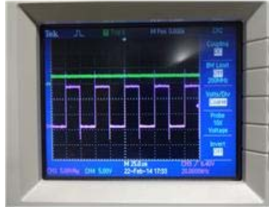
그림 6-3 사용주기(duty cycle)에 따른 PWM출력의 아날로그 평균 및 rms 전압
