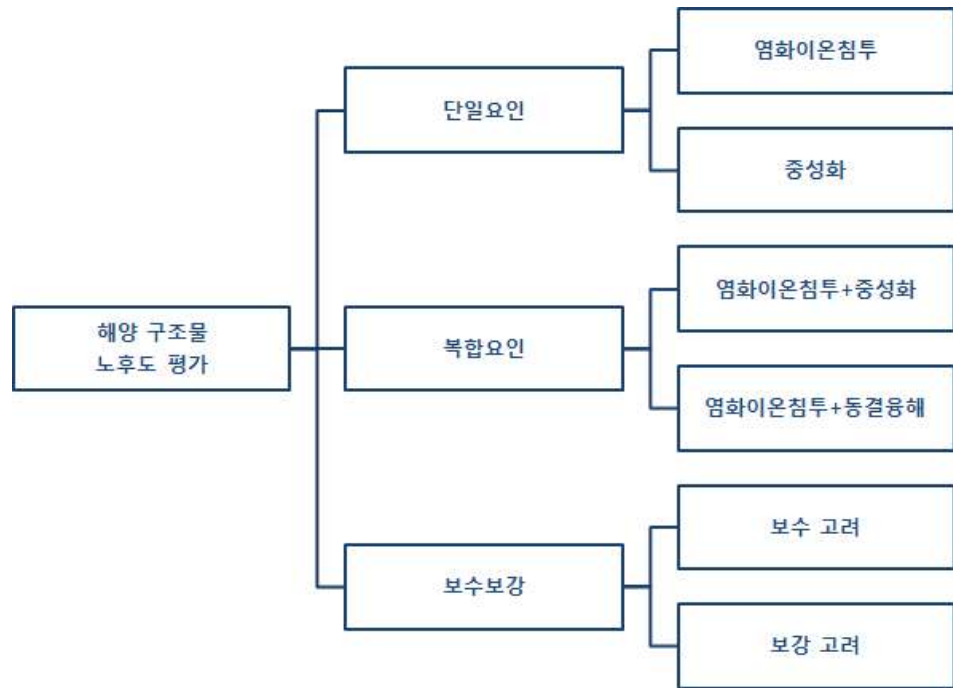
[그림 7-13] 철근콘크리트 구조물의 시나리오별 복합열화 평가 방법
