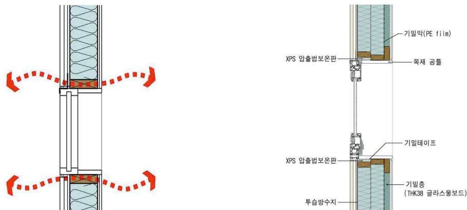
<그림 3.3.1-8> 벽-창호 접합부 문제점과 대안
