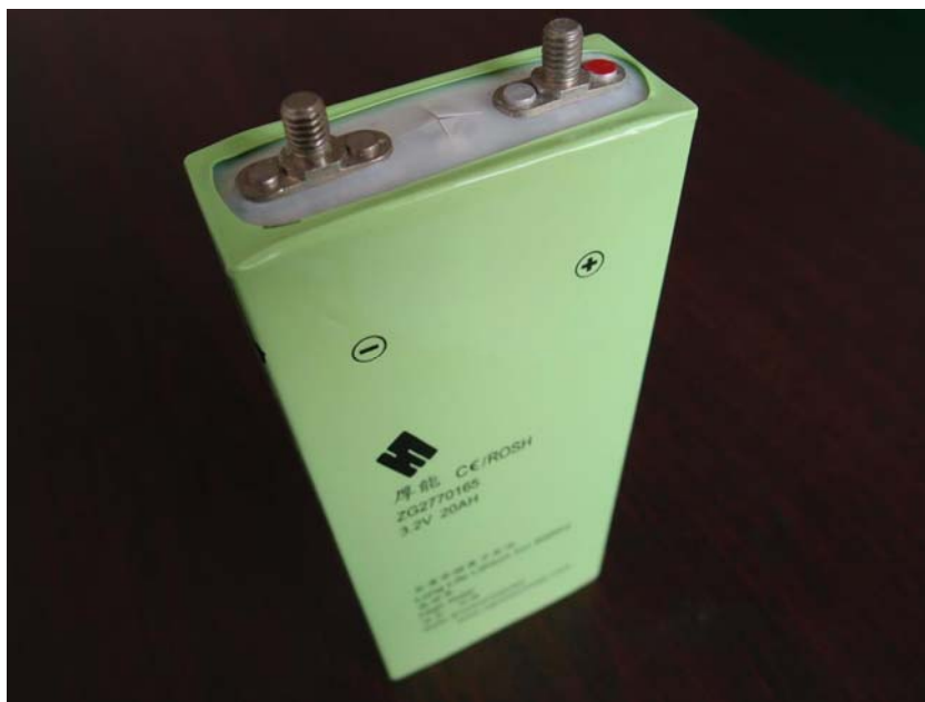
그림 42 리튬인산철 셀 (3.2V 20AH)
