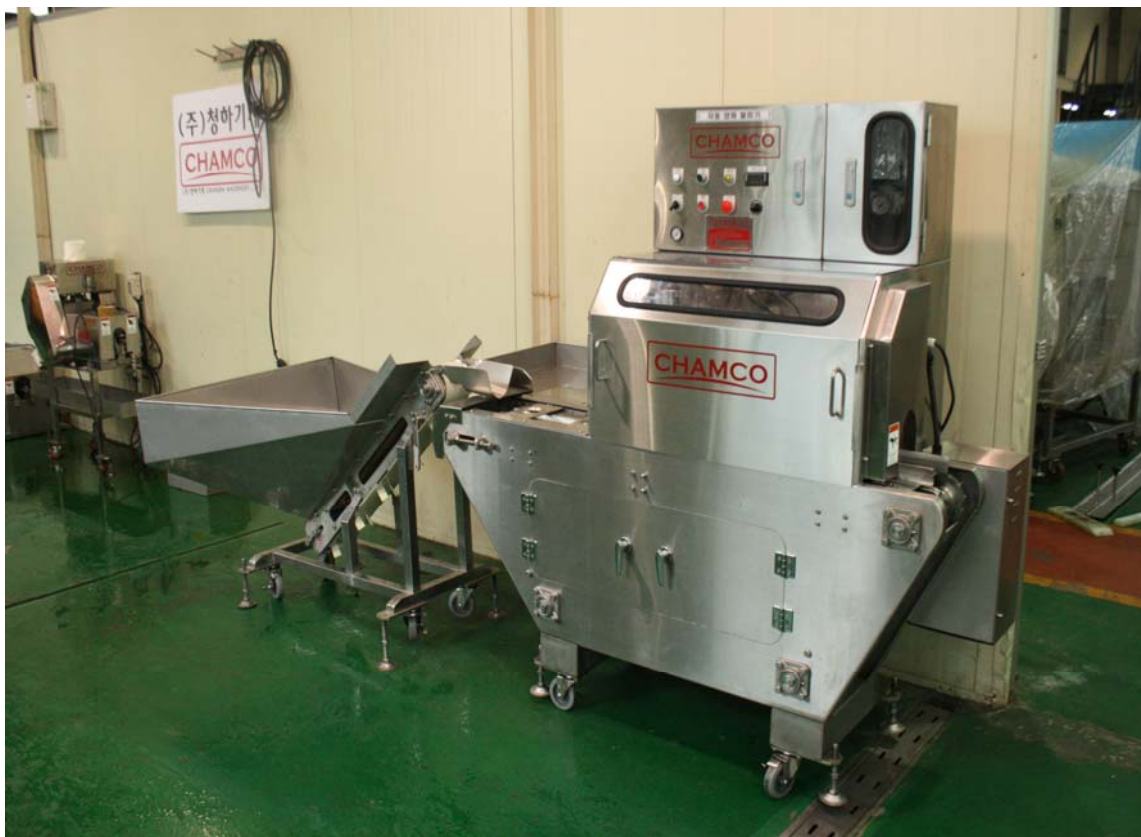
그림 1. 자동 공급기 및 양파 뿌리줄기 절단장치 (소형)
