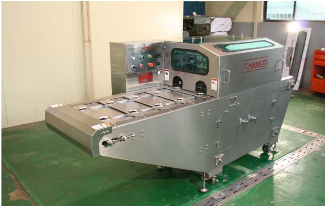
그림 9. 뿌리 및 줄기 절단장치를 내장한 양파탈피기
