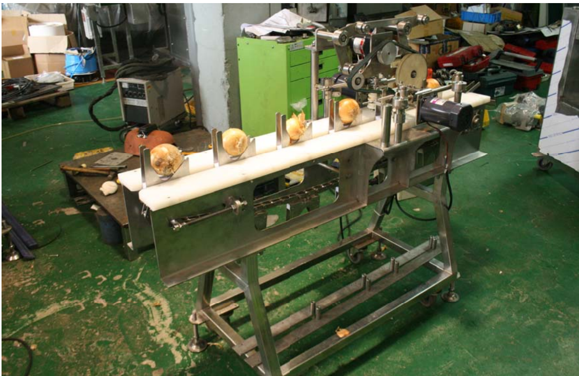
그림 6. 뿌리, 줄기 절단기 전체 사진
