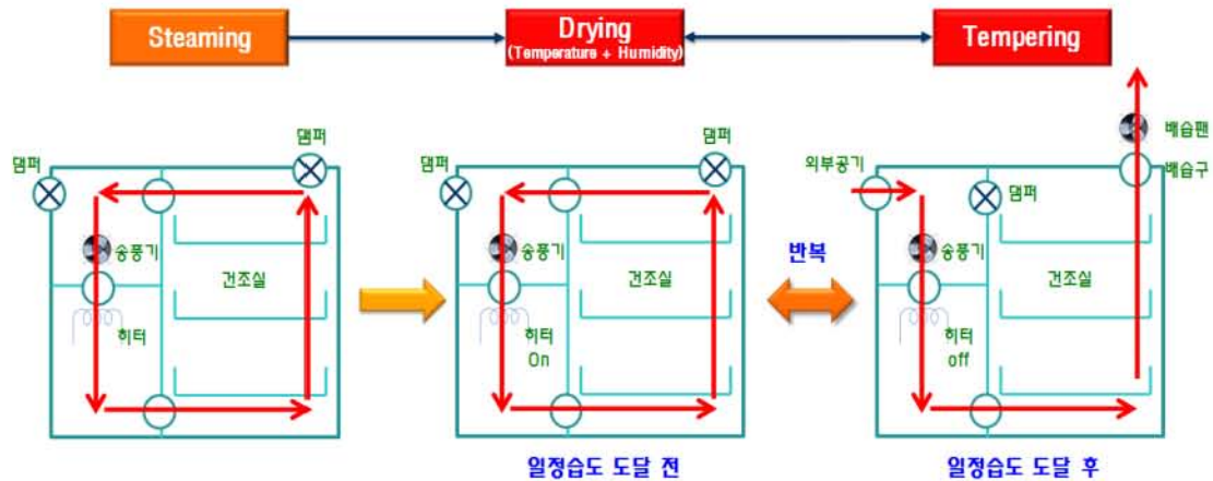
그림 3 개발될 고추건조기의 온습도제어방식의 건조방법
