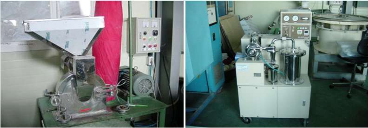
Fig. 47. Trichoderma harzianum GBF-1048균주 분쇄공정장비(좌: Pin miller, 우: Airjet miller)
