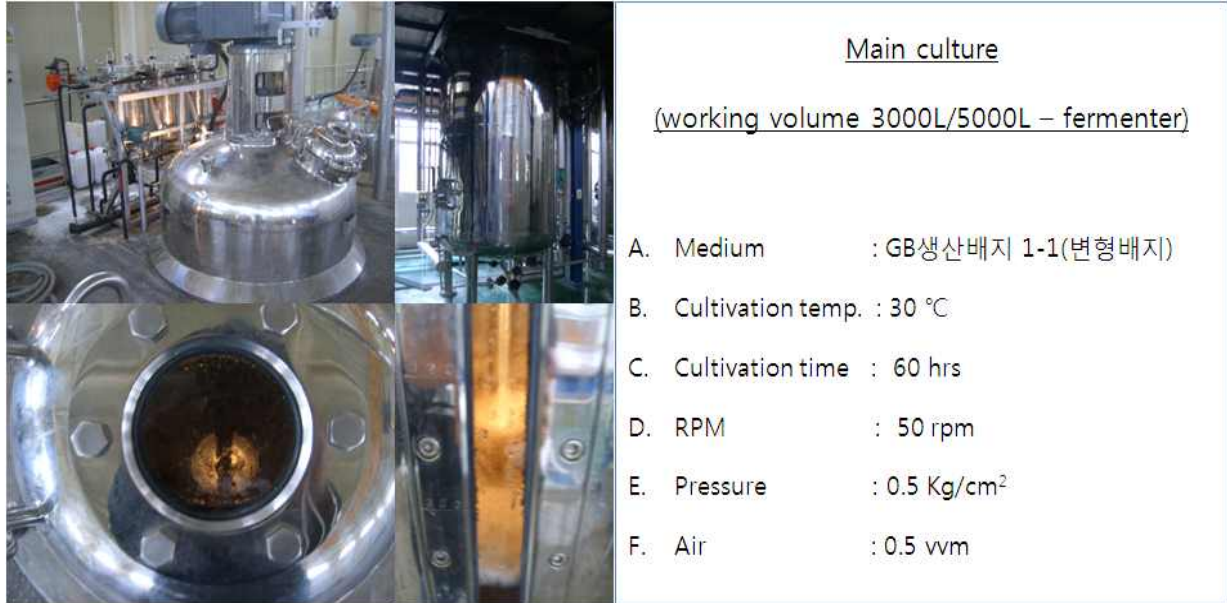
Fig. 11. 5,000L fermenter 모습과 주요 배양조건.
