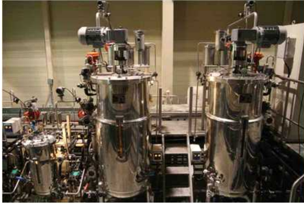
Fig. 8. 500L fermenter 모습과 주요 배양조건.
