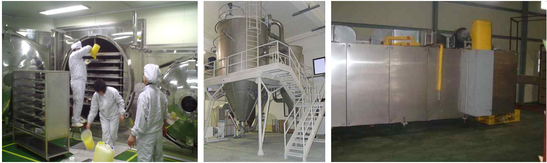
Fig. 21. 건조 제형 제조 방법(동결건조기, 분무건조기, 열풍건조기)
