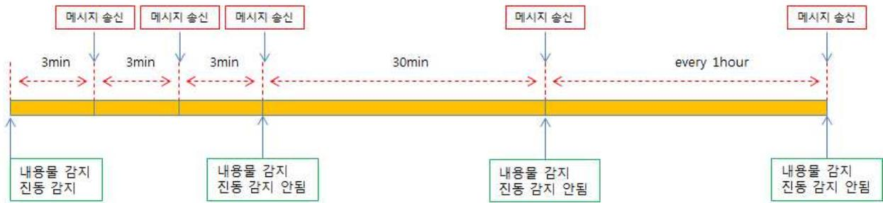
태그에서 내용물이 감지된 상태에서 진동이 발생하면 태그에 저장된 키값으로 back-off 시간을 계산하고 바로 sleep으로 진입후 back-off 시간이 되면 wake-up 해서 데이터를 송신하고 다시 최초 이벤트 발생시간 기준으로 3분이 지나면 같은 작업을 반복한다. 위의 그림과 같이 3번을 통신한 뒤에는 30분 뒤에 한번 통신하고 그 뒤로는 매 시간마다 반복하며 하루가 지나면 1일 1회 통신모드로 진입하여 배터리를 절약한다.
