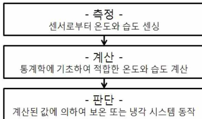
<그림 3-5-2> ‘양계장 제어 시스템’ 수행 순서도(Mohsin Murad ct al.).
