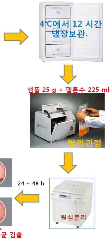
<그림 10> 선택배지 및 PCR을 이용한 즉석식품 내 잔존 미생물의 정성적 존재 확인 및 저감화 연구 방법 모식도
