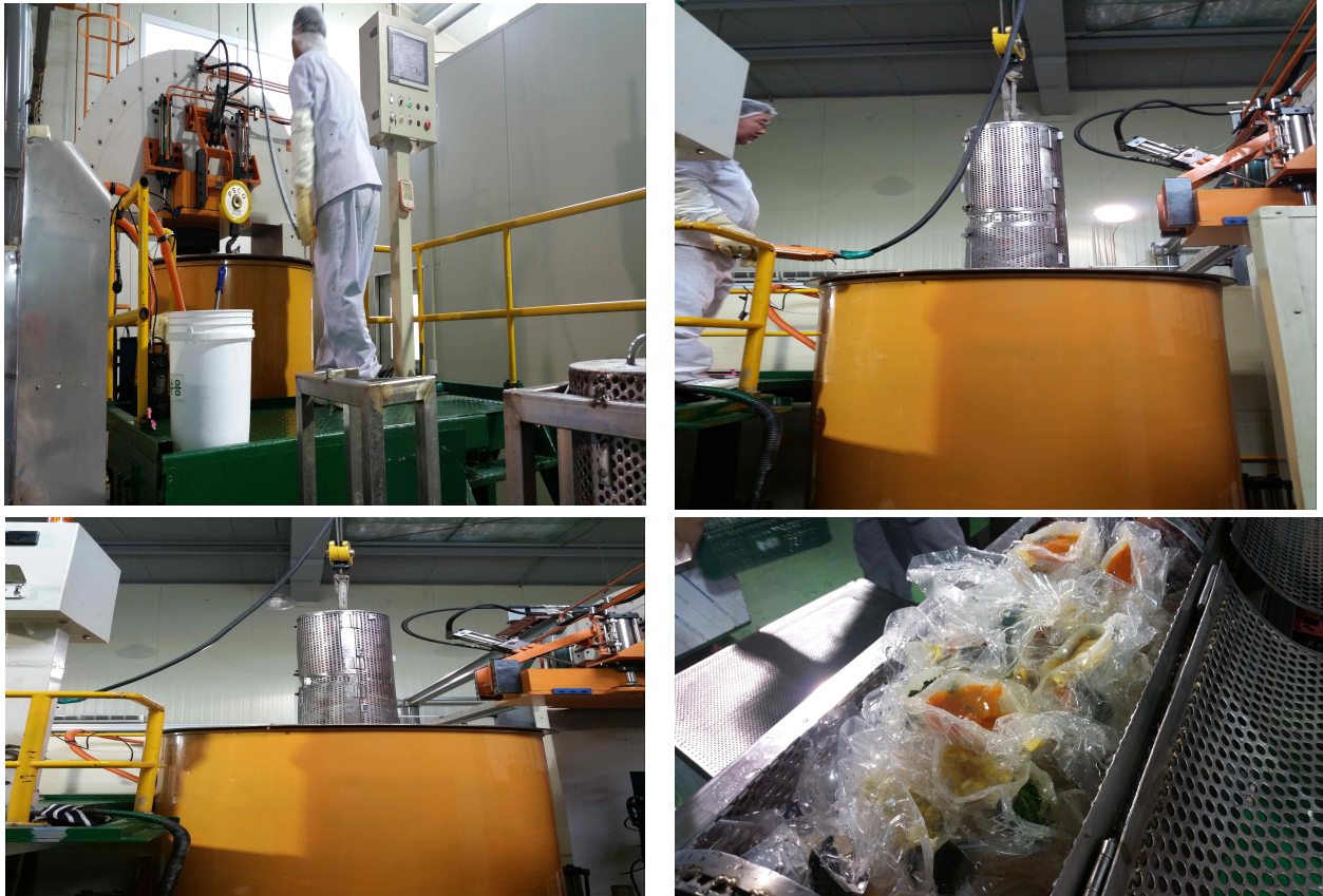
그림46. 진공 포장된 시료가 초고압 멸균 처리되고 있는 모습
