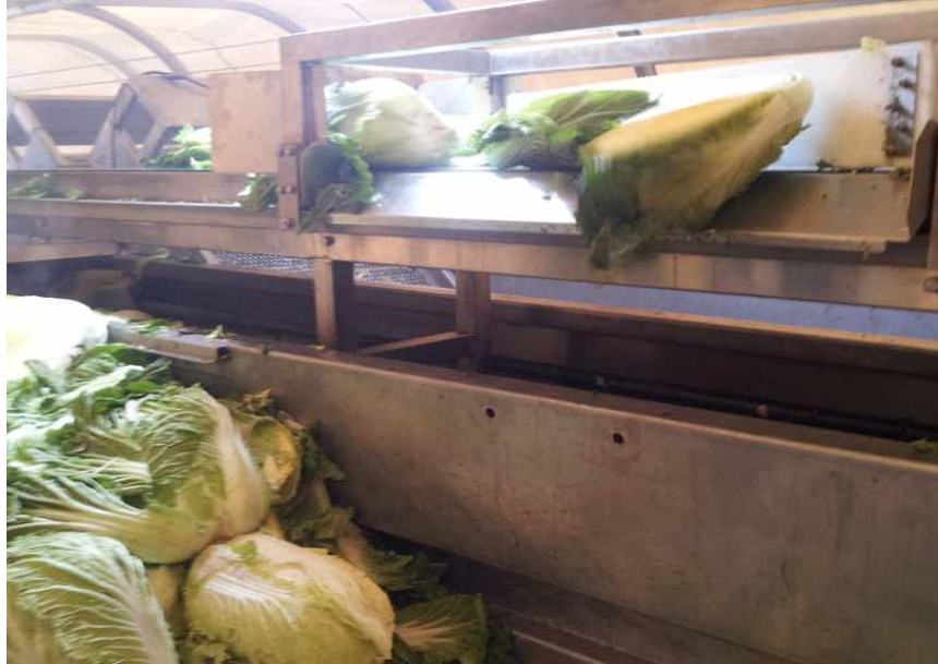
그림 38. 유도장치 및 안내날개에 따라 투입되는 절단배추
