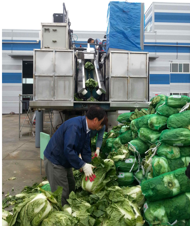
그림 28. 배추의 이절 시험
