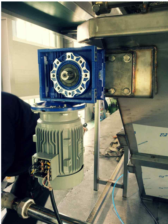
그림 23. 절임배추 밀기장치 구동시스템
