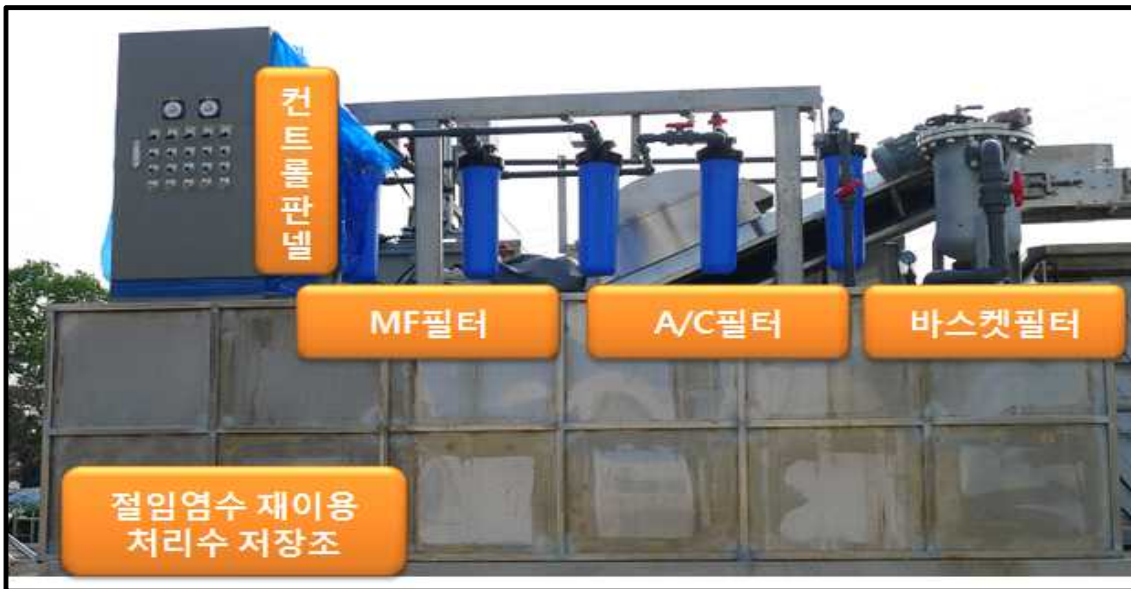
그림 7. 절임염수 재사용 장치 우측 설치도
