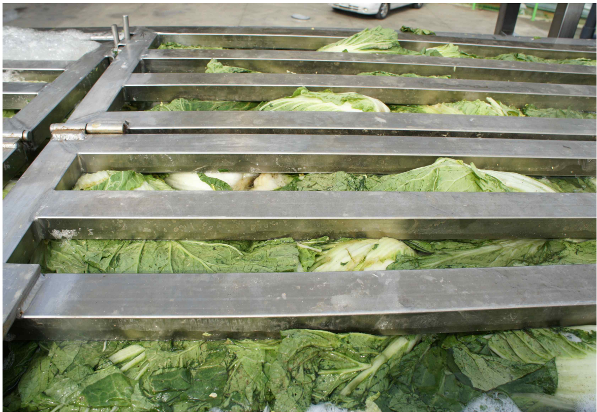
그림 29. 배추를 절임조에 넣고 덮개를 잠근 후 염수 주입 시험
