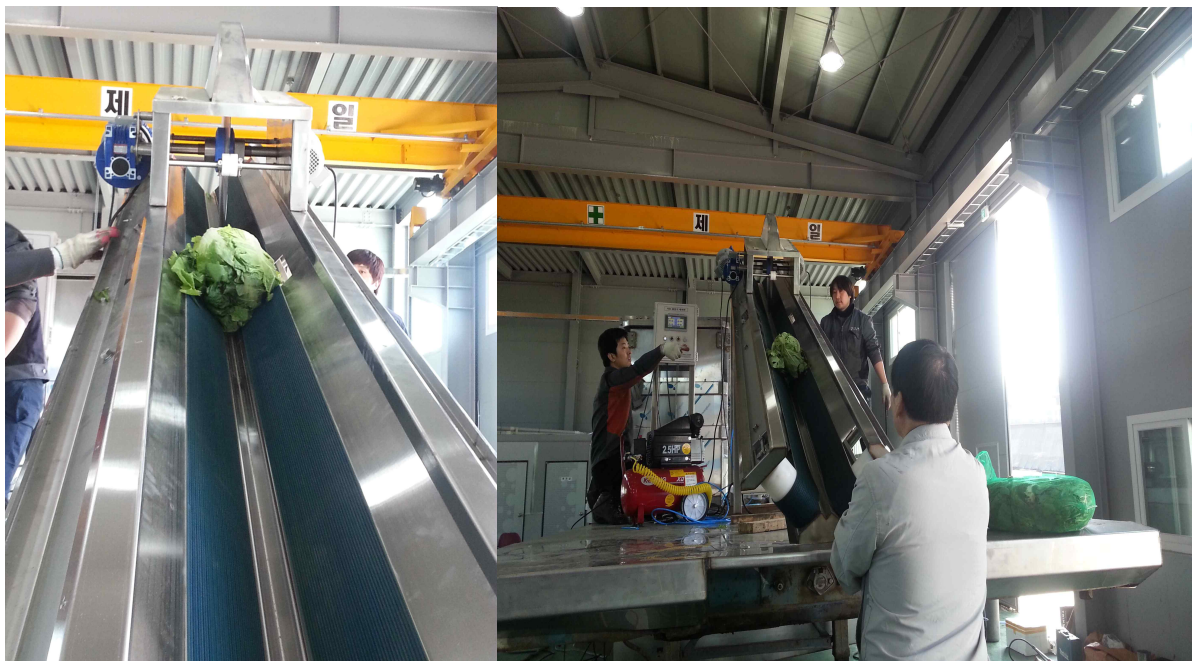
그림 13. 이절기와 칼집내기식으로 배추를 절단하는 시험
