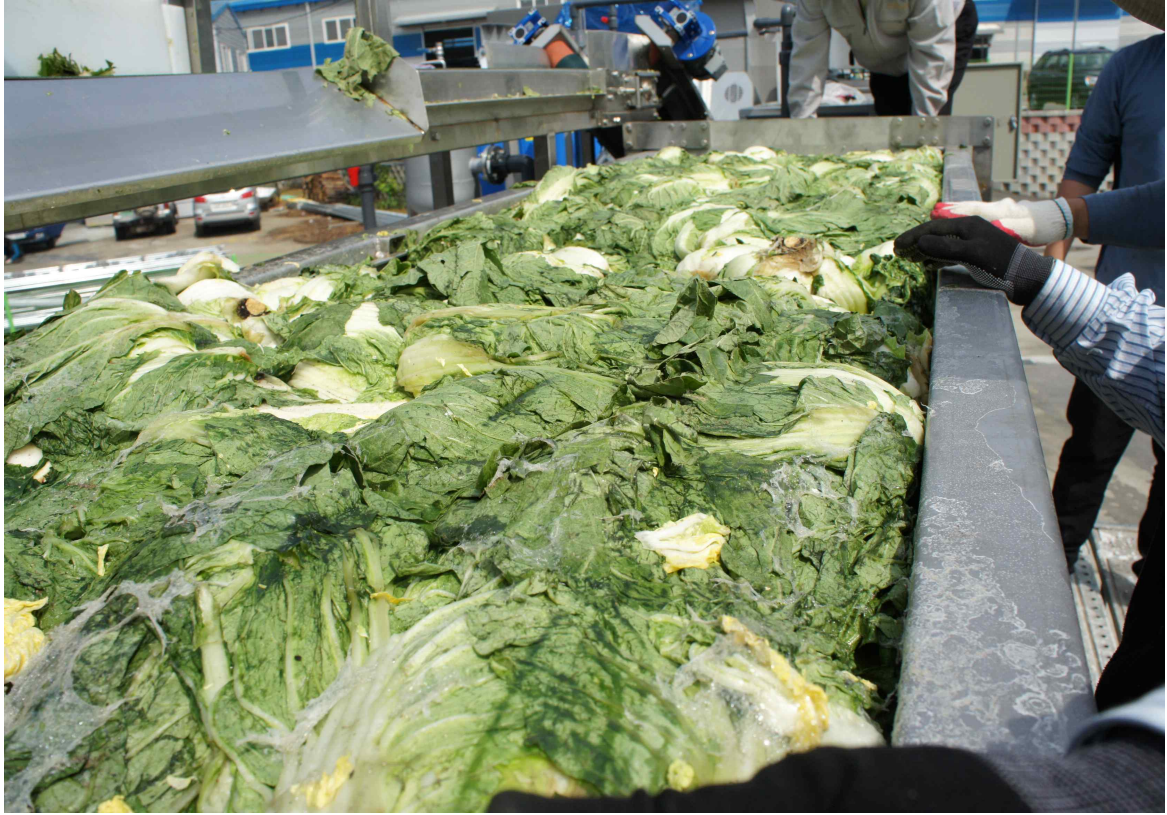
그림 30. 절임배추의 밀기장치 운전 시험
