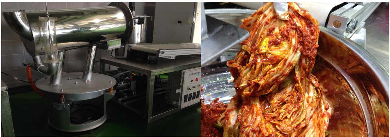
그림 84. 경사교반식 양념소넣기 장치 시험
