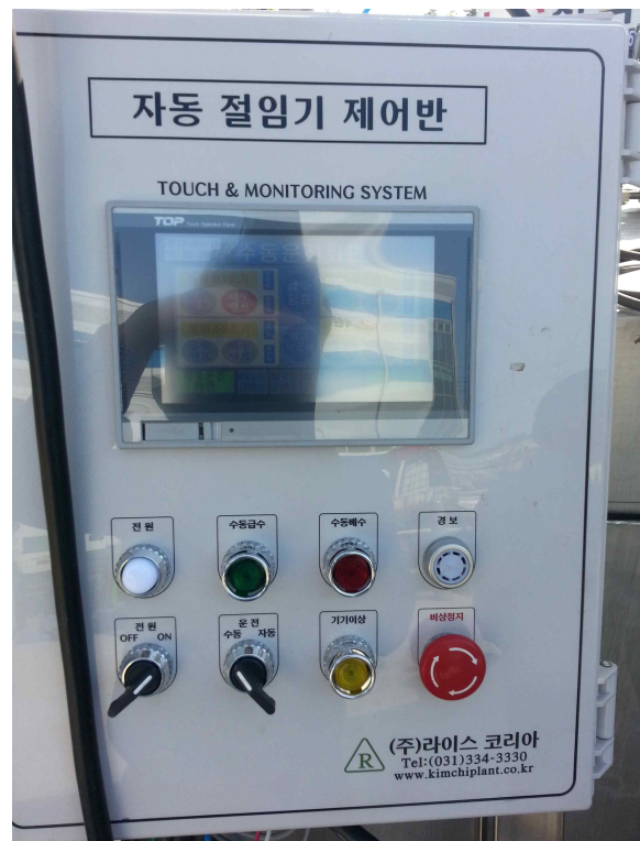
그림 19. 염수 주입과 배출 자동화 제어시스템
