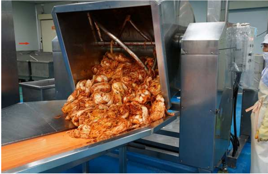
그림 85. 수평교반식 혼합기를 사용한 김치제조 시험
