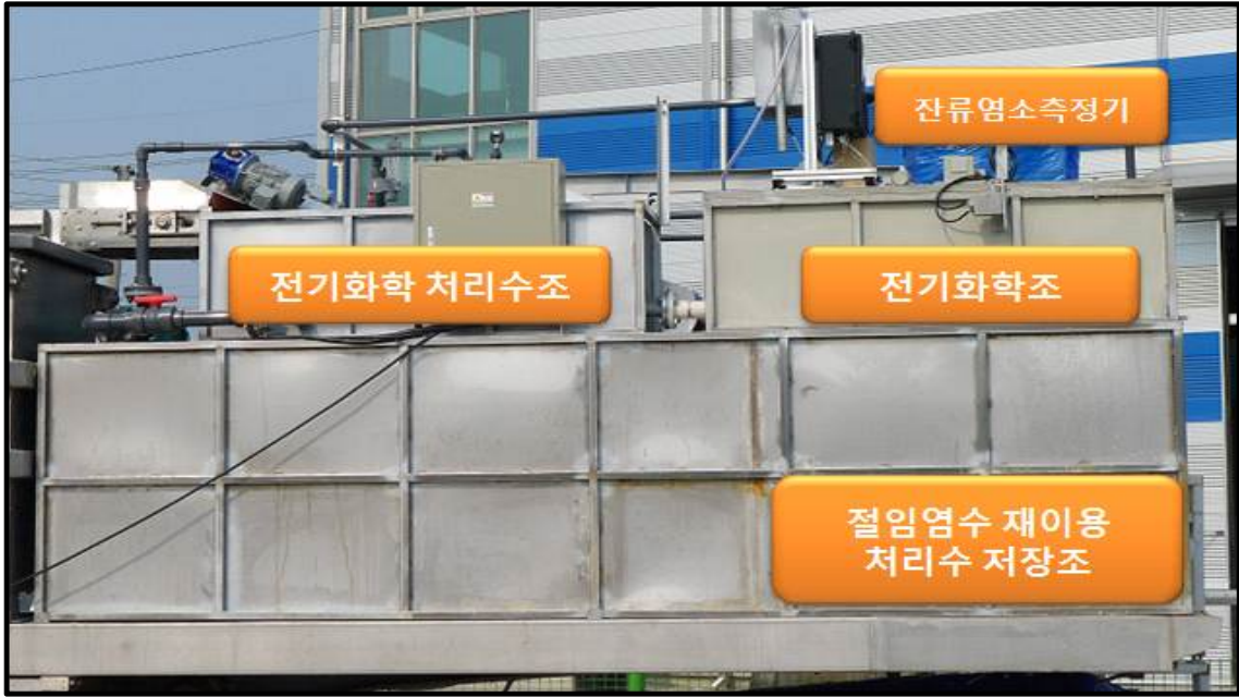
그림 8. 절임염수 재사용 장치 좌측 설치도
