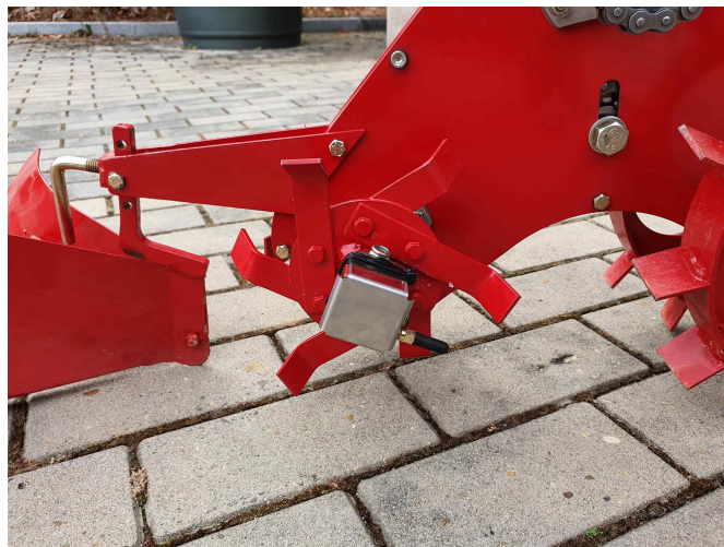
<그림 3-8> 무선 송신 장치 부착
