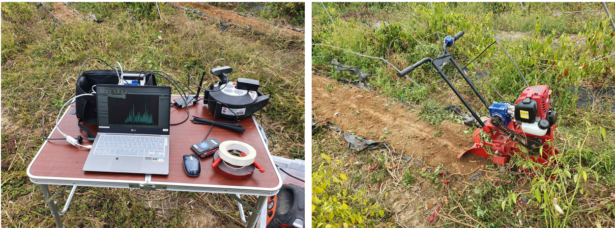
<그림 3-22> 2차 시작기 토크 측정 시험
