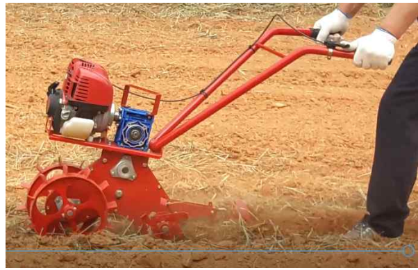
그림 2-2 시작품 1호기 수직 제초날 방식
