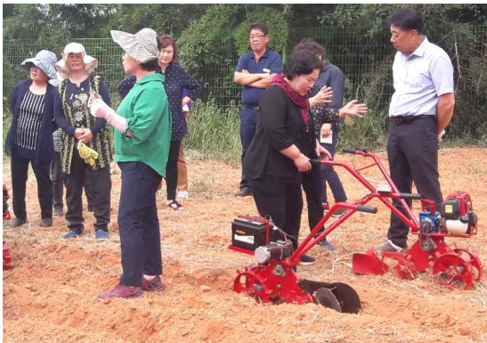
그림 2-3 시작품 1호기 현장시험
