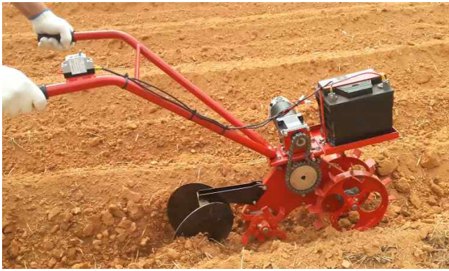
그림 2-2 시작품 1호기 수직 제초날 방식
