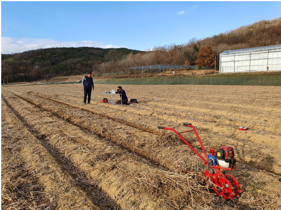
<그림3- 10> 1차 시작기 토크 측정
