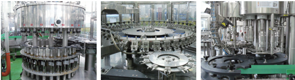
그림 3-62 약주 포장용 로터리충진기
