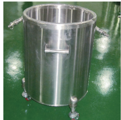
그림 3-21 2중 재킷 방식의 밀술탱크
