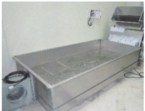
그림 3-17 강제 송풍기가 설치된 고두밥 냉각기
