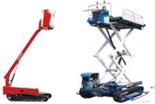
그림 17 붐 및 테이블형 고소작업차(MARUYAMA,일본)
