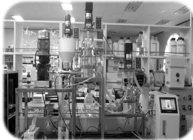
그림 3.5-64. 연속식 투입 동시당화발효 장치
