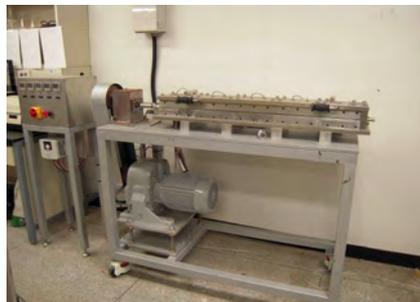
그림 3.2-43. Continuous Twin Screw-driven Reactor (CTSR)
