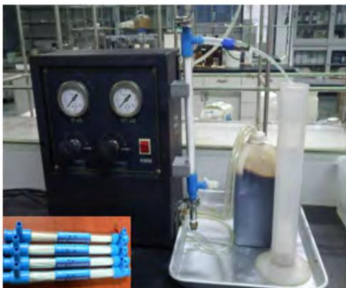
그림 3.5-42. 중공사막을 이용한 회수 장치
