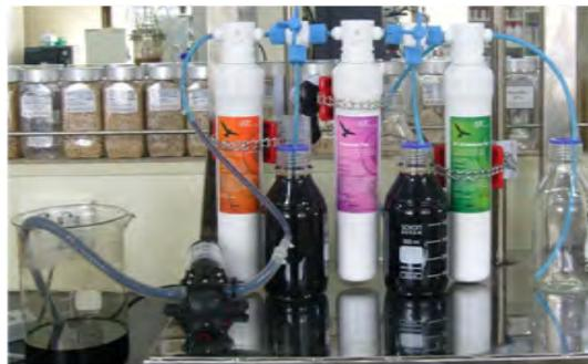
그림 41. NaOH 회수 간이 실험 장치
