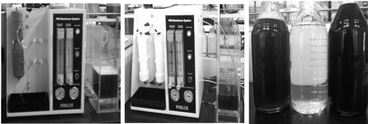
그림 3.5-73. 여과 사진 (UF, NF, 여과액)
