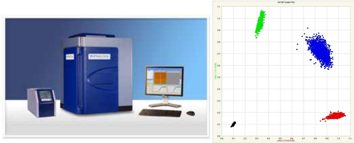
<Fig. 14> BioMark™ HD system과 유전형 분석 결과. 48개의 시료와 48개의 SNP 분자마커 또는 96개의 시료와 96개의 SNP 분자마커 유전형 분석 결과를 한 번의 실험을 통해 얻을 수 있다.
