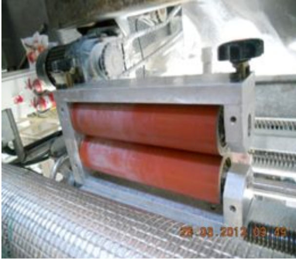
그림38. 보조가이드를 사진 & 개선 효과사진 첨부
