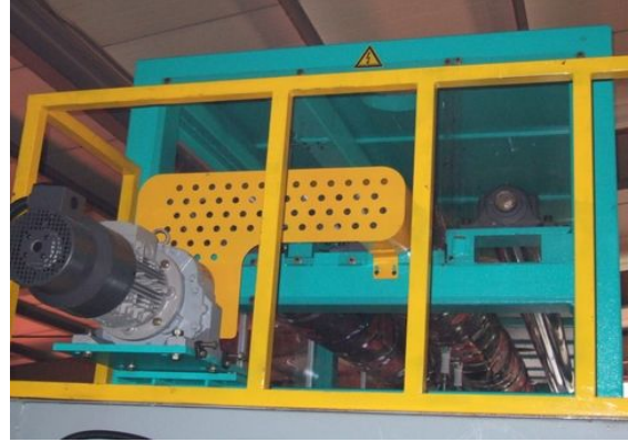
그림30. 코로나처리기 설치 전 후
