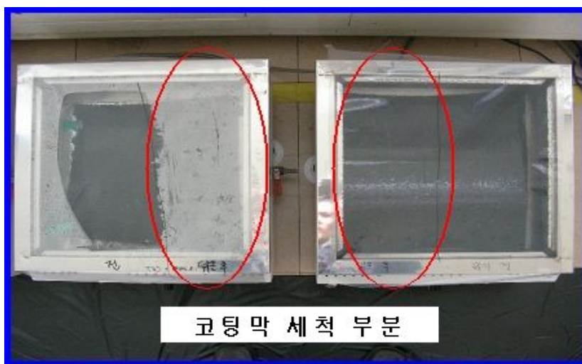
그림9. 국내 장기성 코팅필름과 일본 장기성 코팅필름의 유적 코팅막 세척 후 유적 경시 비교
