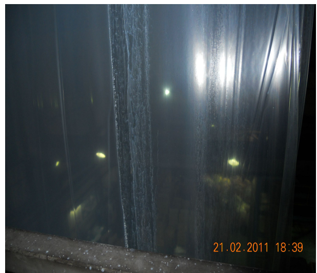
그림37. 압출 가공 시 접힘 부분 주름에 의한 코팅과다 현상
