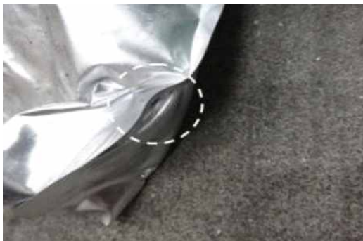
그림 2-16. 낙하충격에 의한 기존 포장 및 개선 포장의 파손
