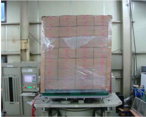
<삼계탕 포장 파렛트 화물 진동시험> 그림 2-13. 삼계탕 파렛트 화물 진동시험
