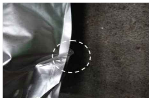
그림 2-16. 낙하충격에 의한 기존 포장 및 개선 포장의 파손
