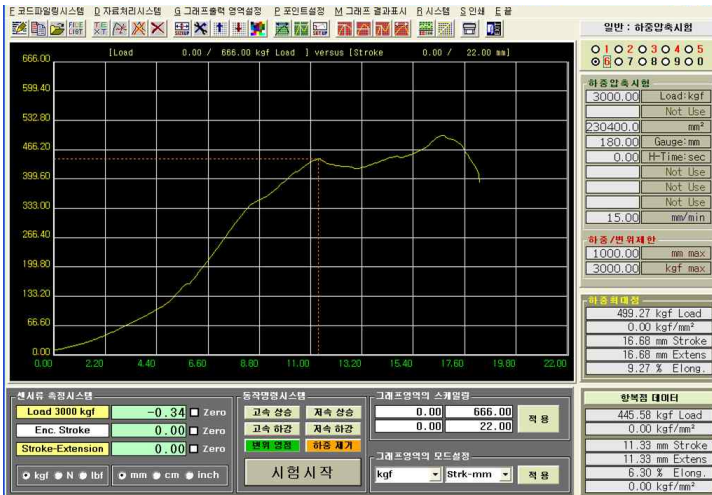
그림 89. The view of compression test using UTM
