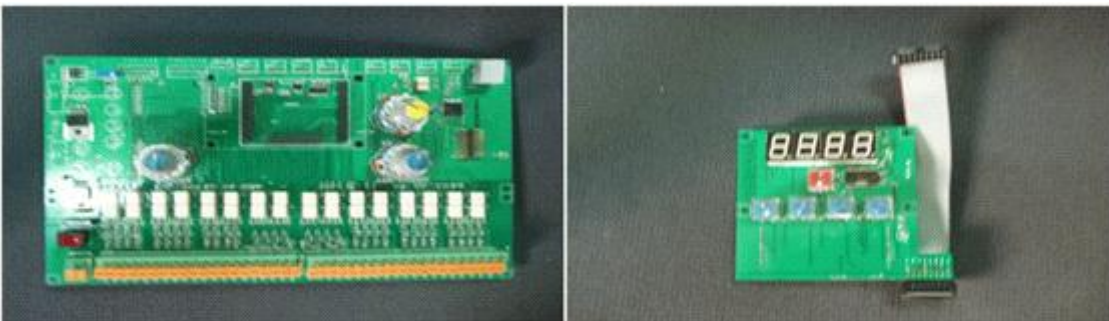
그림 4. 온실내 환경인자 입출력 및 제어를 위한 메인보드 및 세븐세그먼트출력방식 기판
