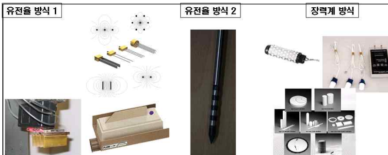
그림. 독자 모델의 방향: 유전율 방식 2종과 장력계 방식 1종
