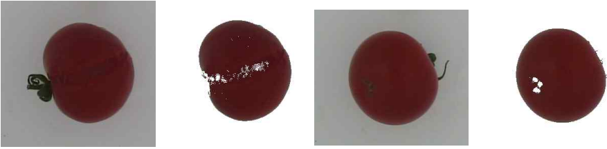
그림 4. Results of imaging processing for detecting bad tomatoes
