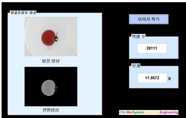
그림 8. Imaging processing of cherry tomato in the developed programing
