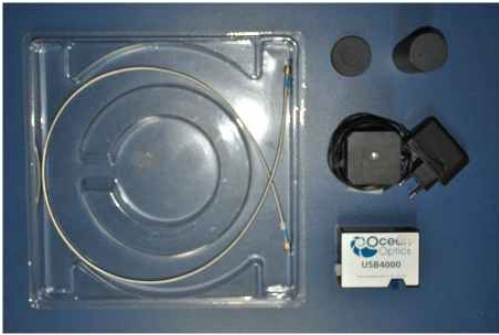
그림 31. Components of a prototype for nondestructive spectral measurements
