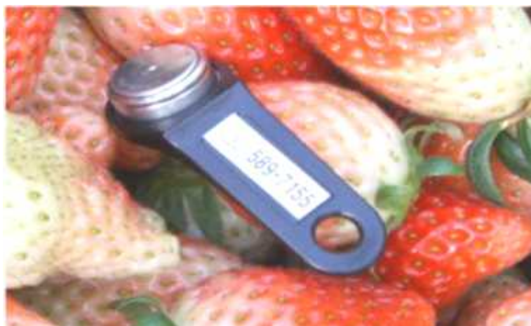
[그림 3-Ⅲ-108] 온·습도 추적 장치(DS1923L-Maxim Integrated, USA).
