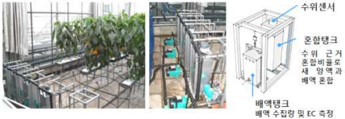
[그림 3-I-30] 농가 보급용 순환식 수경재배 모듈의 실험구 설치 모습(좌)과 장치 개요(우).
