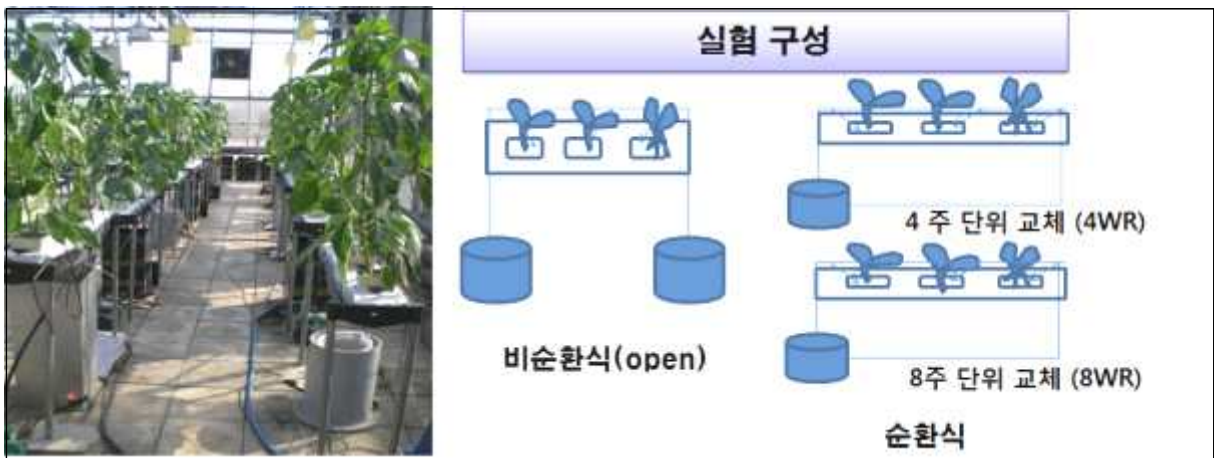
[그림 3- I -50] 재사용 양액의 교체주기 실험 장면(왼쪽)과 구성도(오른쪽).
