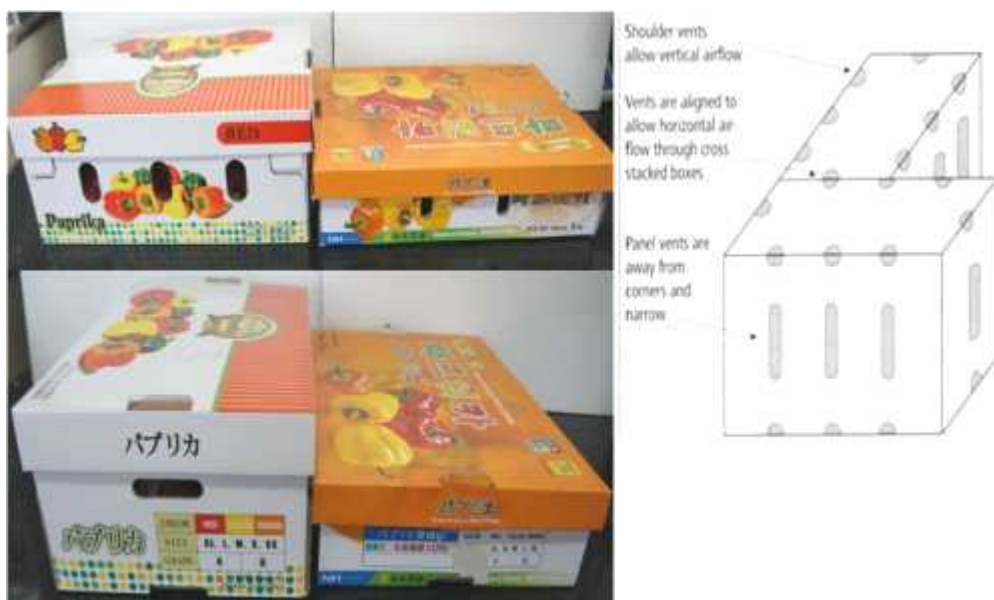
[그림 3-III-13] 국내 파프리카 상자 예냉을 위한 통기구 상태와 권장 통기구 구조
