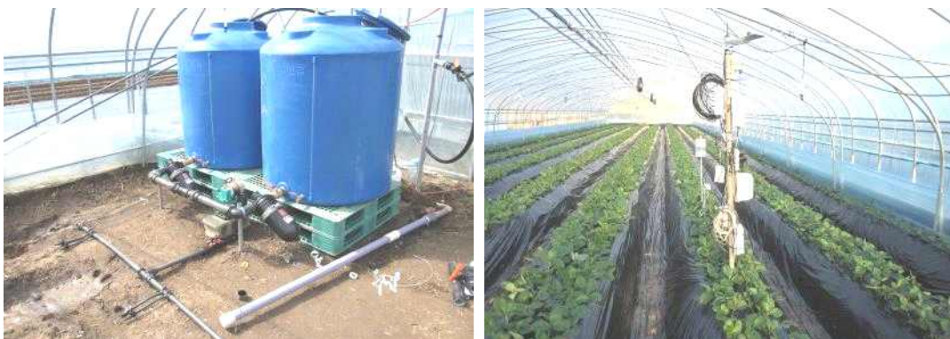
[그림 3-I-149] 농가에 설치된 자동 급액, 관비 시스템.
