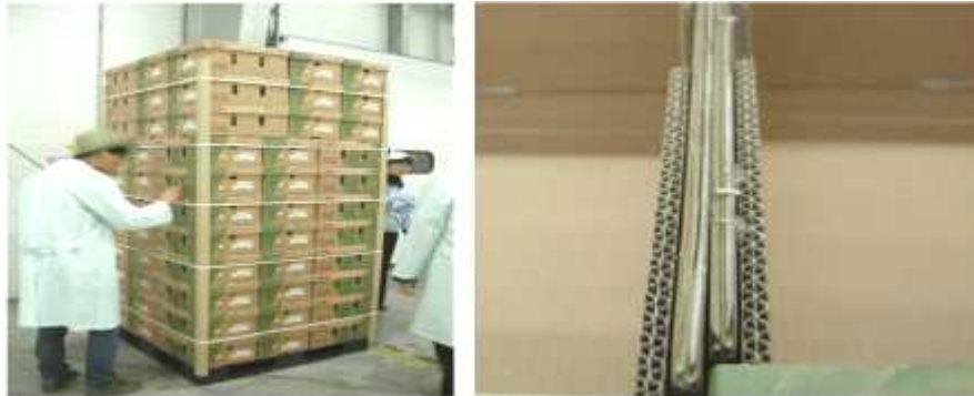
[그림 3-III-9] 포장상자 강도 강화와 선적시 박스 고정.
