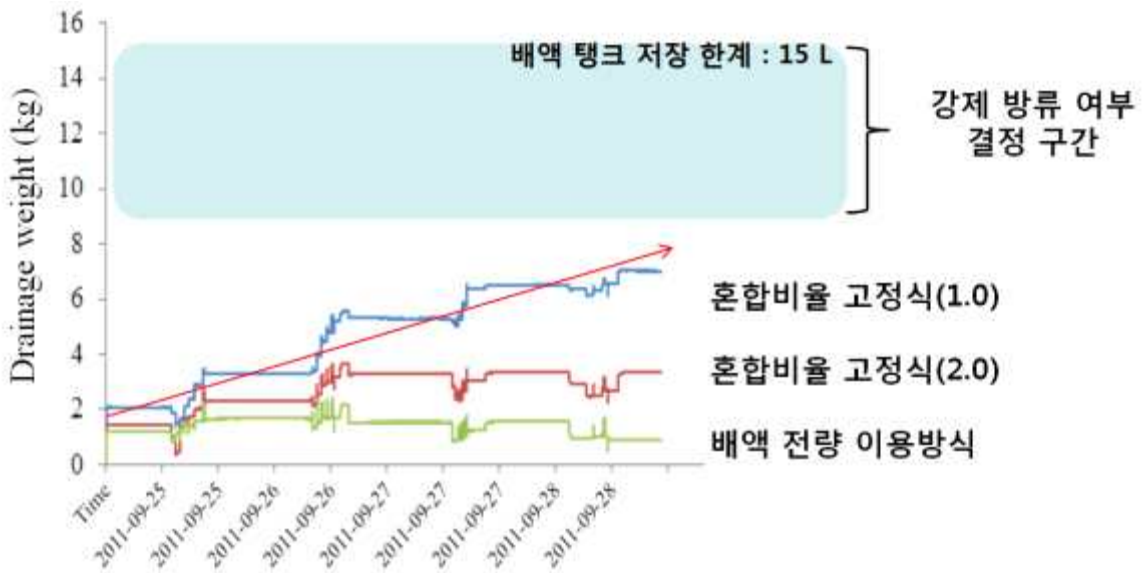
[그림 3-I-34] 재사용 양액의 혼합방식에 따른 배액 탱크 내 배액 저장량 변화.
