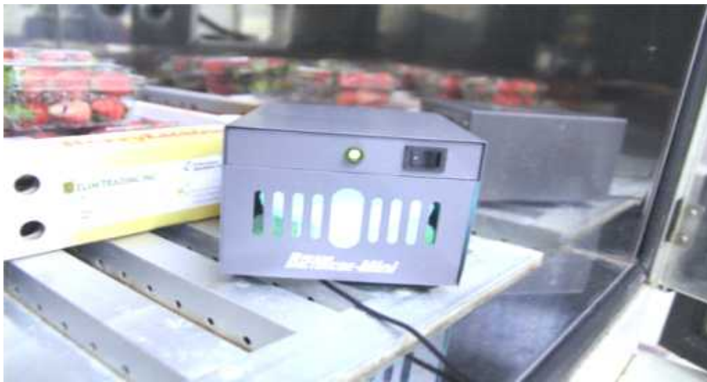
[그림 3-III-123] 수출딸기 ‘매향’에 처리한 ClO 2 발생장치.
