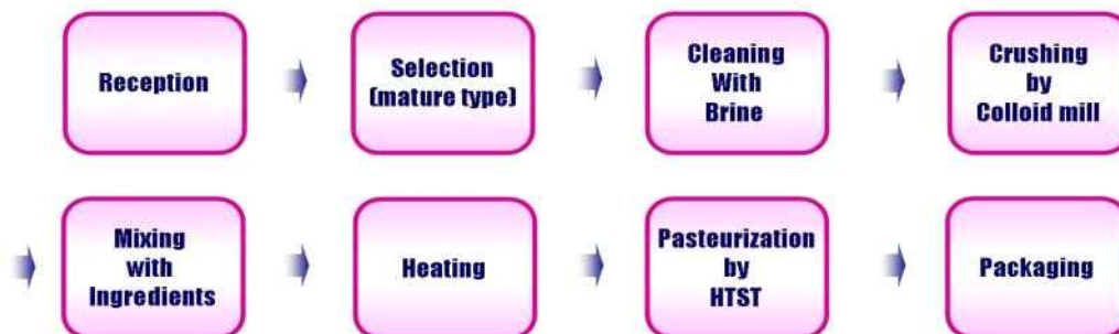
[그림 3-III-182] 딸기 음료 생산을 위한 기초 제조 공정도.
