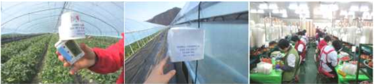
[그림 3-Ⅲ-132] 수출딸기 재배 온실 내부(왼쪽) 및 외부(가운데), 선별장(오른쪽) 내부의 온·습도 측정 및 수집장치.
