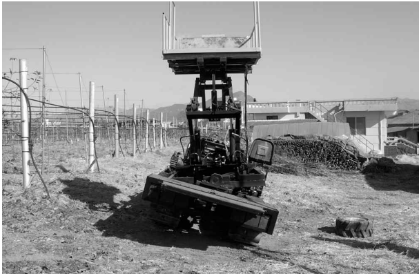
그림 2-130. Balancing demonstration of latitudinal level control.
