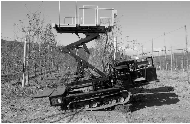
그림 2-132. Balancing demonstration of longitudinal level control
