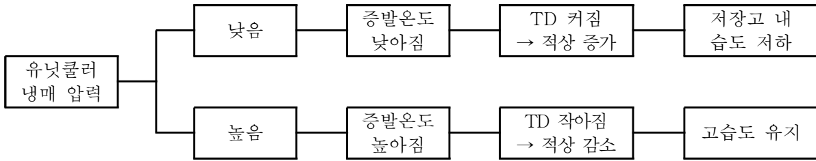
그림 3-1. 냉매압력-냉매 증발온도-TD의 관계에 따른 저장고 상대습도 변화 양상.
