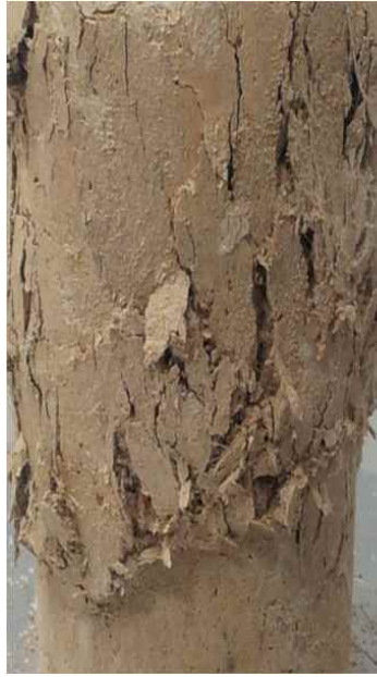
〈그림 45〉 시멘트-벤토나이트-섬유 혼합토의 파괴양상
