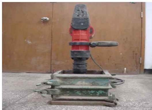
<그림 125> Hilti vibrating machine and CSG block mould
