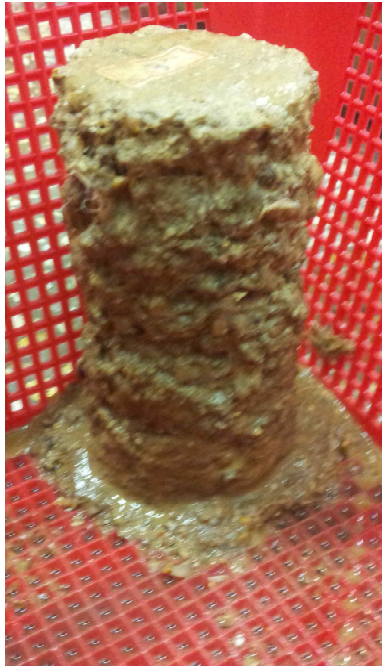
<그림 69> 벤토나이트 혼합토의 수중양생 후 시료의 모습
