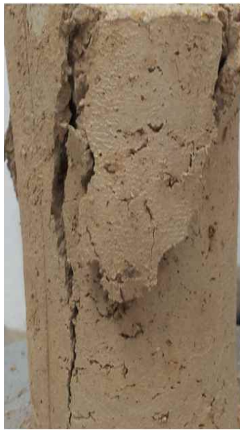
〈그림 46〉 시멘트-벤토나이트-메타카올린 혼합토의 파괴양상
