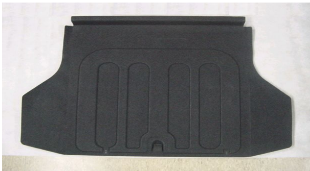
Fig 32. 오븐프레스 공정을 통한 개발제품 (시제품)
