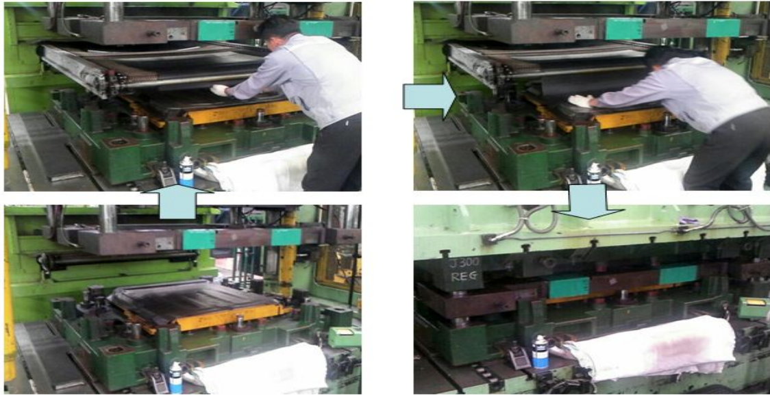
Fig 168. 성형 조건을 설정하기 위한 양산 금형 Test
