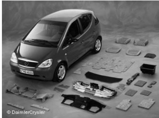
Fig 189. 독일 다임러크라이슬러사에서 실용화 연구 중인 바이오복합재료를 채택한 자동차 부품
