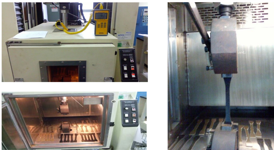
Fig 162. 내열내구시험을 위한 열간신율 측정
