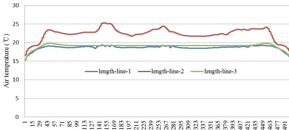
Fig. 3.2.35. 25일령 HRV 환기 구조 시스템 (-15°C 외기 유입), 30초 환기 후 길이 방향 별 온도 모니터링
