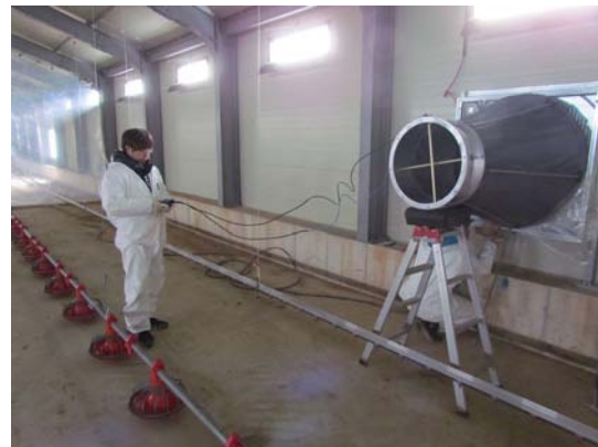
(b) Manometer를 이용한 풍압/풍량 측정
