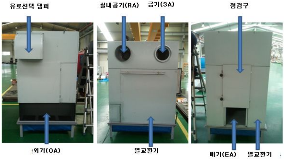
Fig. 3.5.41 폐열회수 환기장치 1차 모델
