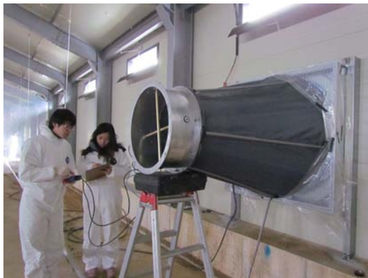
(a) 팬 풍량 측정을 위한 실험기구 설치
