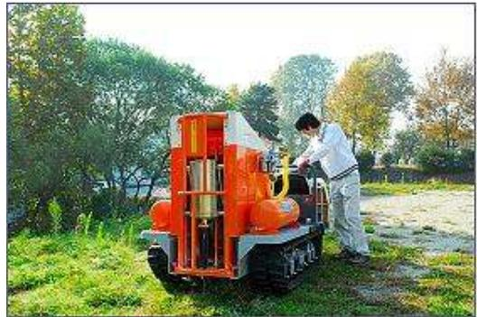
그림 3-40. 토양개량제 계량시험 장치와 시험광경
