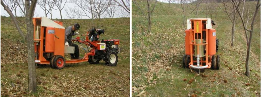
그림 3-58. 경운기 부착용 심토개선기 작업능력 시험
