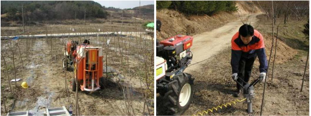
그림 3-51. 조경수 식재지의 심토환경 개선기 적용 시험
