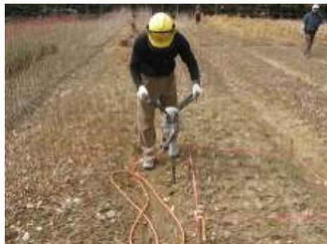
그림 3-47. 묘포장에서의 심토 개선기 현지적용 시험 (경운기용 심토 개선기)
