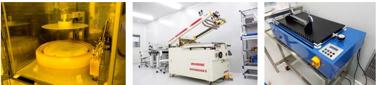
[그림 48] 필름제조장비 (좌:Spin Coater, 중:Screen Printer, 우:Blade Coater).
