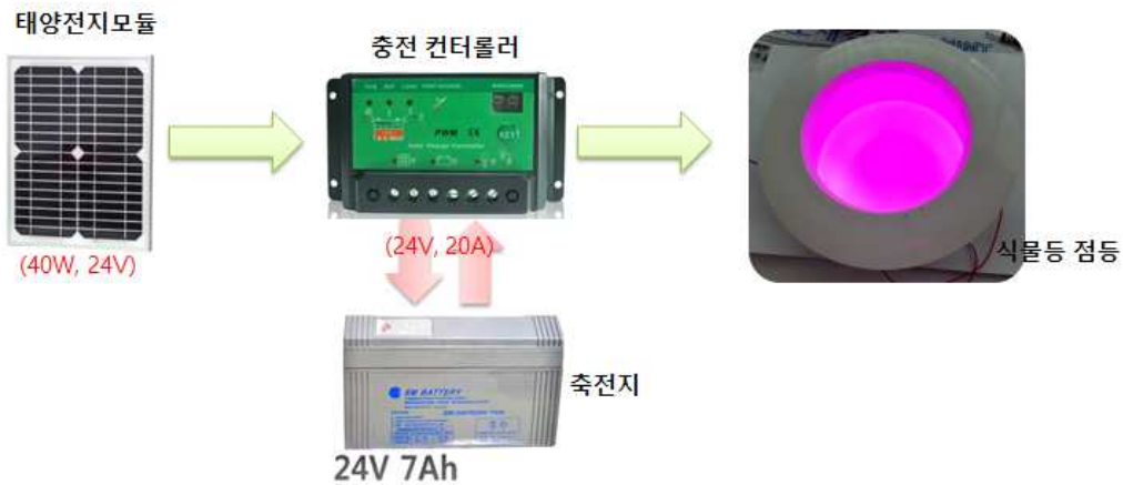
[그림 106] 태양전지형 식물성장등 전원공급 구조.
