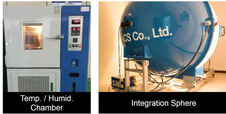
[그림 57] 퀀텀닷 필름, 사출캡의 안정성 평가에 사용된 항온항습기(좌), 적분구(우) 장비.
