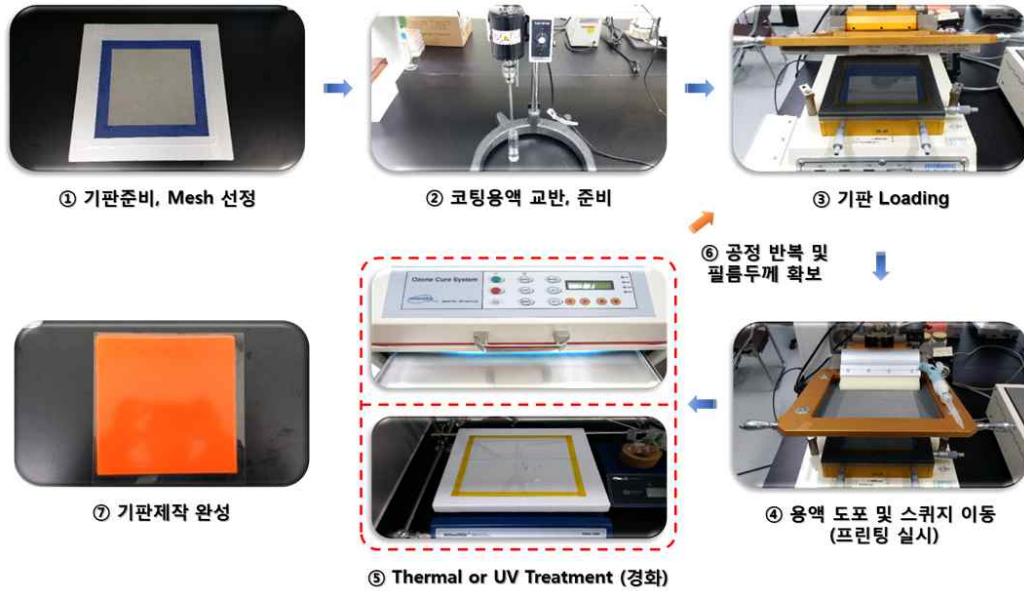
[그림 39] 퀀텀닷 필름 제조 공정 순서(screen printing).
