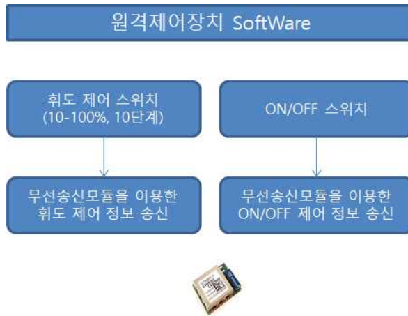
[그림 110] 무선송신제어기의 Software 구성도.
