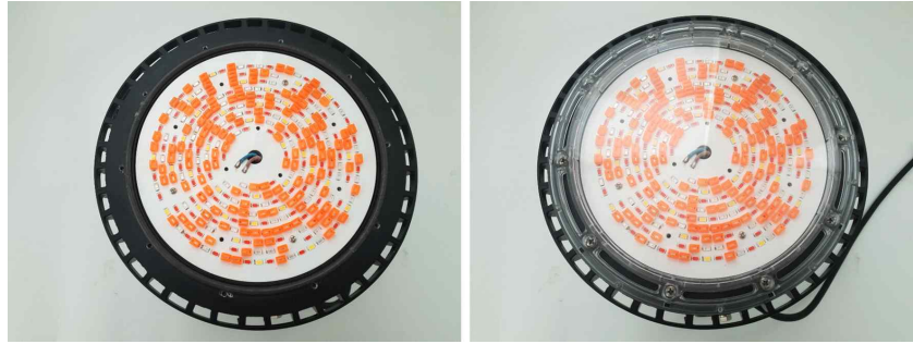
[그림 104] 100W급 식물성장조명의 등기구효율 측정을 위한 Acryl Cover 적용 전(좌), 후(우).
