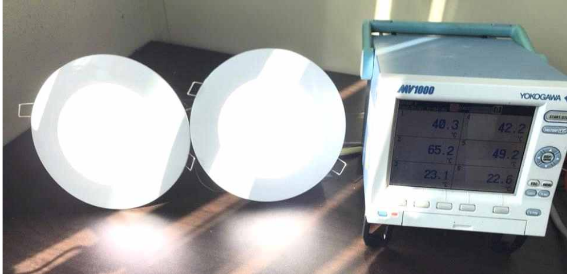
(a) 방열소재 미적용 모델(좌), 적용모델(중) 및 온도측정장치(YOKOGAWA MV1000, K-type Thermocouple) (우)
