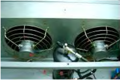
그림 3.34 냉동유닛의 입구측 건습구 온도 측정 및 주요부위 온도·압력 측정
