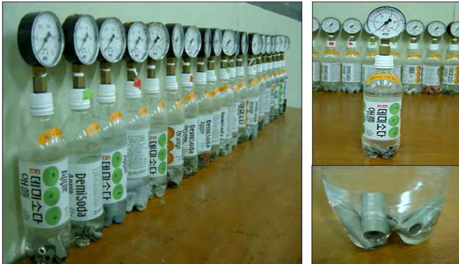
그림 3.14 후보 PCM의 금속부식 특성 시험
