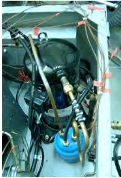
그림 3.34 냉동유닛의 입구측 건습구 온도 측정 및 주요부위 온도·압력 측정
