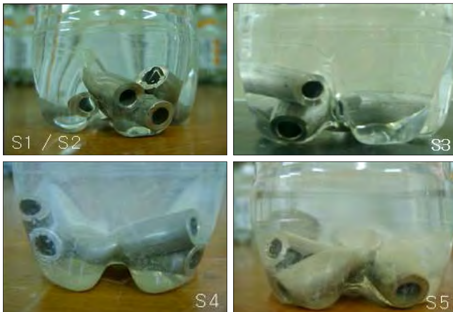
그림 3.18 각 후보 PCM과 SUS304의 부식 특성
