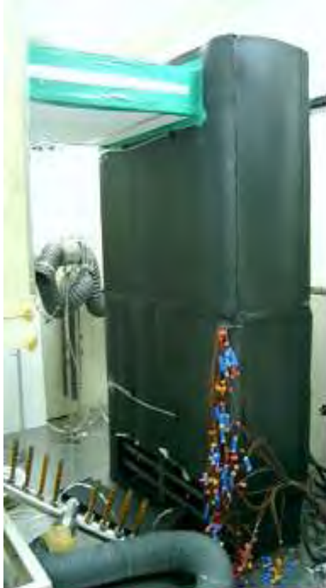
그림 3.33 PCM 열교환기의 단열 후 풍동에 연결된 모습(좌/우상), 입구측 건습구 온도 측정
