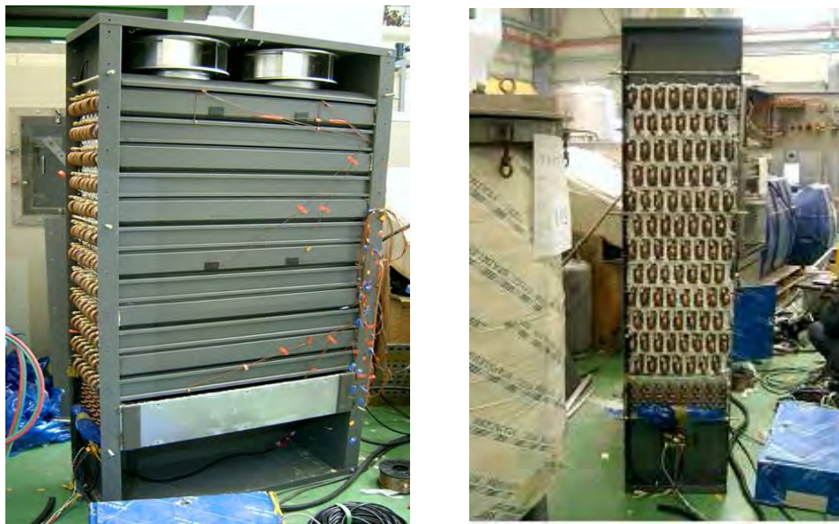
그림 3.30 PCM 열교환기 전면 및 측면 센서 부착 과정
