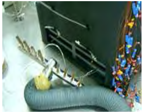
그림 3.33 PCM 열교환기의 단열 후 풍동에 연결된 모습(좌/우상), 입구측 건습구 온도 측정
