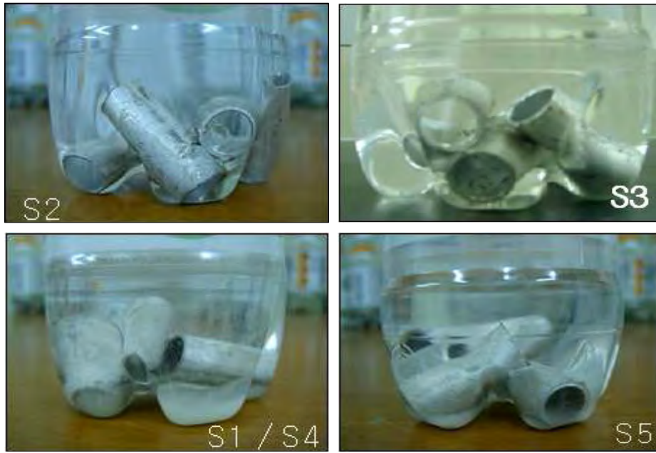
그림 3.17 각 후보 PCM과 알루미늄의 부식 특성
