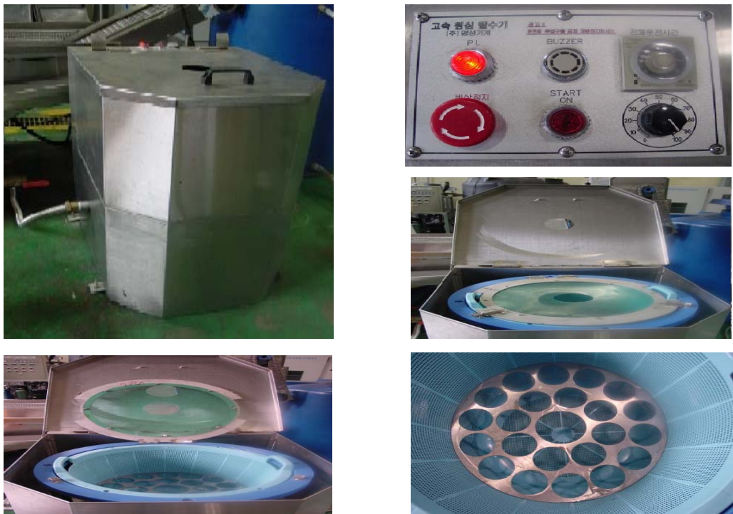
그림 33. 탈수기의 현장 설치 사진
