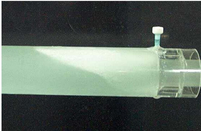
그림 7. 급격한 축소관에서의 아이스슬러리의 거동
