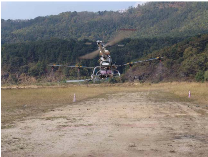
그림 36 ) 시작기 헬리콥터의 비행시험 및 방제 실험 장면
