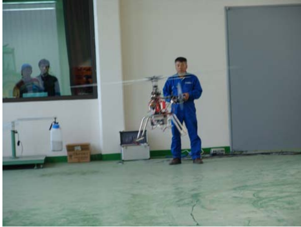
그림 19 안전항법 시스템 실내시험
