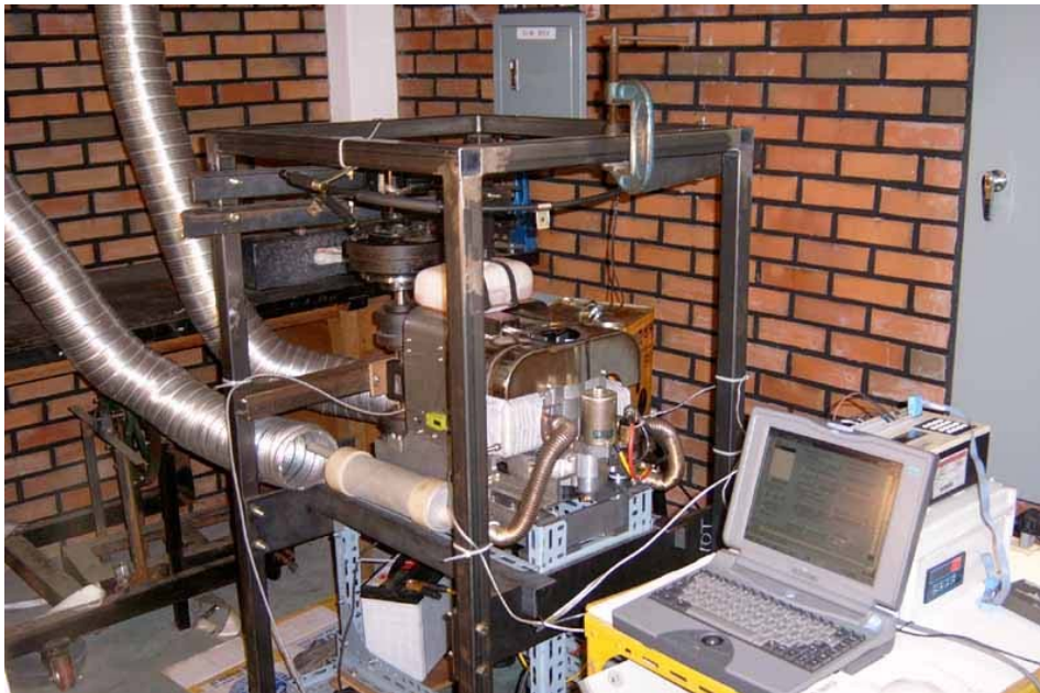
그림 4 ) 엔진 성능 측정을 위한 동력계의 구성 지를 판단하는 기준이 되었다.
