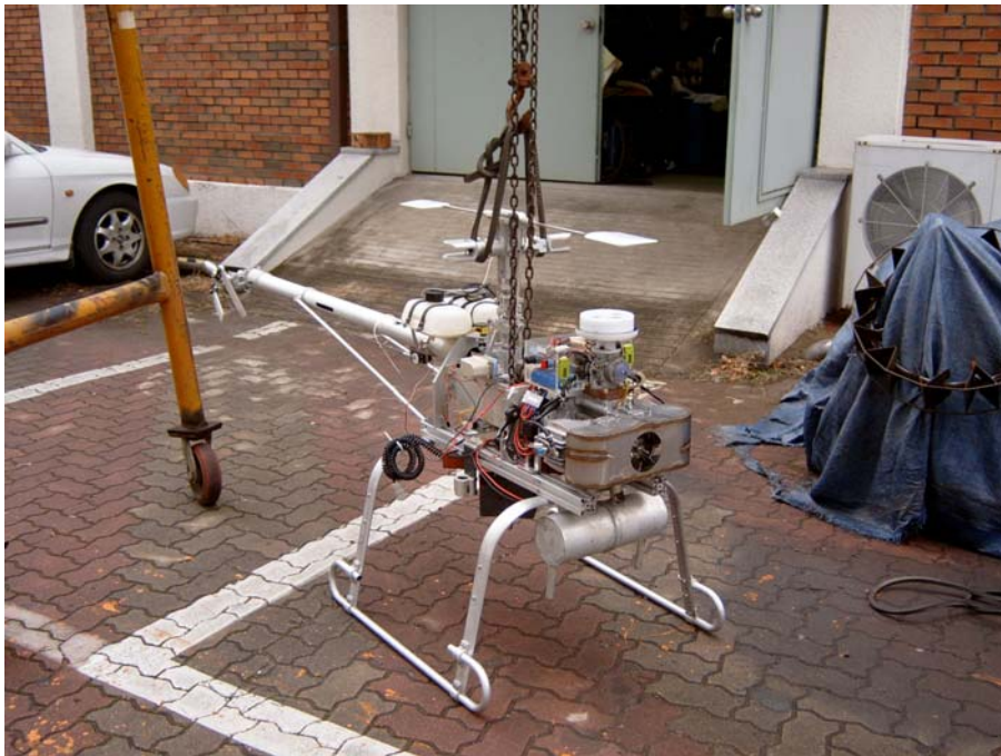
그림 27 ) 개발된 헬리콥터의 조립도면과 무게중심의 설정과정
