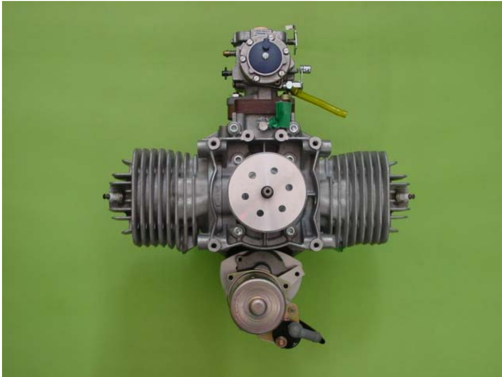
그림 3. 선발된 공랭식 2-cycle 엔진 3M(240-B2)
