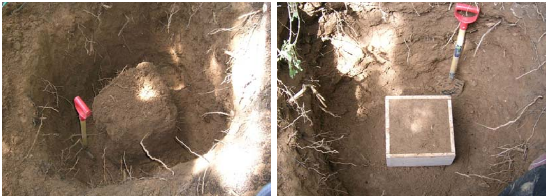
그림 4.33 Box sampler에 의한 불교란 시료 채취
