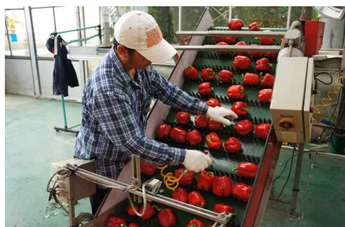
원물투입 및 에어컨작업 (꼭지 및 표면부분 이물질 제거-수출검역 필수사항)
