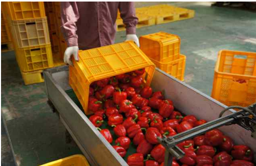
원물투입 및 에어컨작업 (꼭지 및 표면부분 이물질 제거-수출검역 필수사항)
