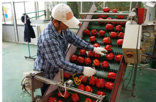
원물투입 및 에어컨작업 (꼭지 및 표면부분 이물질 제거-수출검역 필수사항)
