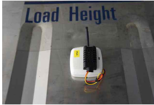
실시간모니터링 시스템 1차 설치작업 (파프리카 적재전 컨테이너에 온습도 센서 설치)
