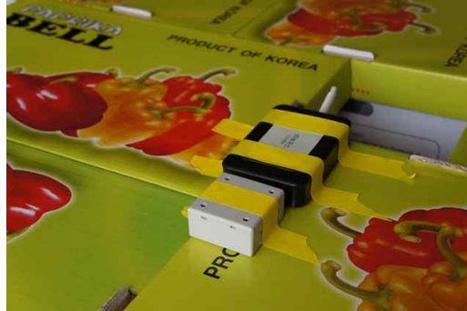
실시간모니터링 시스템 2차 설치작업 (상자 내부에 온습도 센서 설치 및 외부에 CO2 센서 설치)
