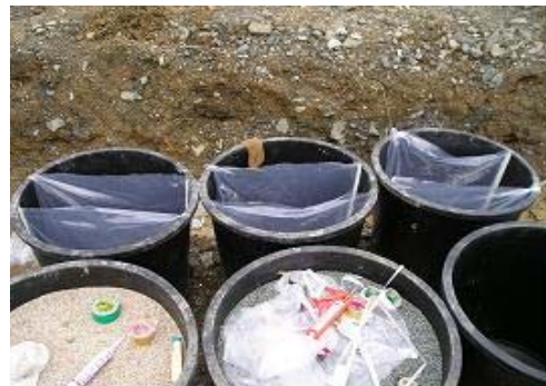
혐기성조 오염용수 유도판 작업
