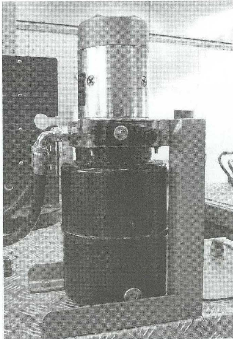
그림 3-20. 수확 및 전정 시스템 대차 수평자세 유지장치 구동용 유압파워유닛
