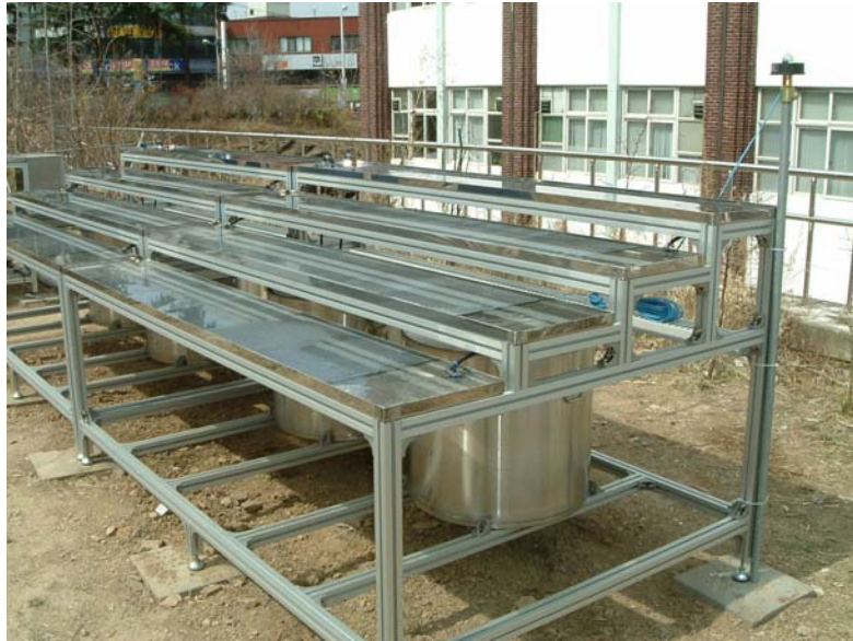
그림 26 가시광응답형 산화티탄 광촉매에 의한 배양액 살균 및 정화 시스템 모델
