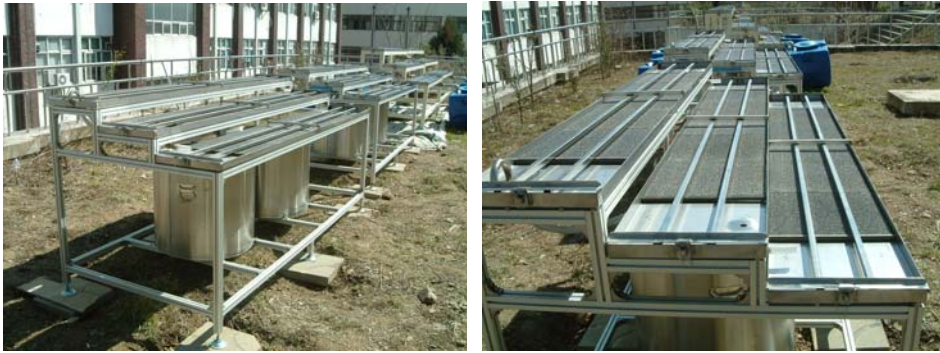
그림 17 가시광 응답형 산화티탄에 의한 배양액 살균 및 정화 기본 시스템
