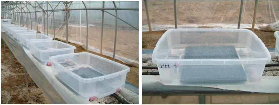
그림 18 산성 배양액에 침적한 광촉매 세라믹 코팅 필터의 광촉매 성능 변화 시험
