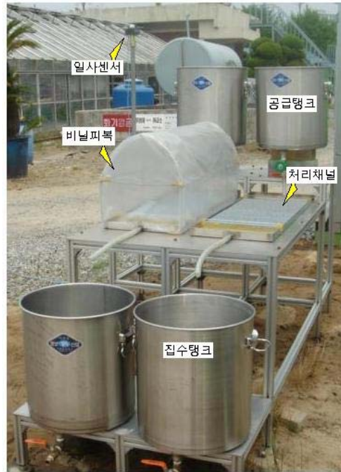
그림 35 비닐 피복 하우스 내 시스템 설치 시 살균성능 저하 시험장치
