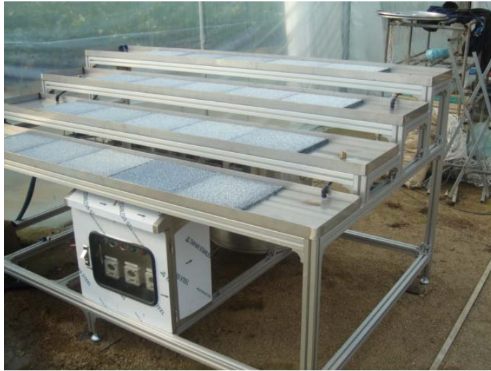
그림 39 가시광 응답형 산화티탄 광촉매에 의한 살균 정화 시스템 (산청 딸기 고설 수경재배 온실내)
