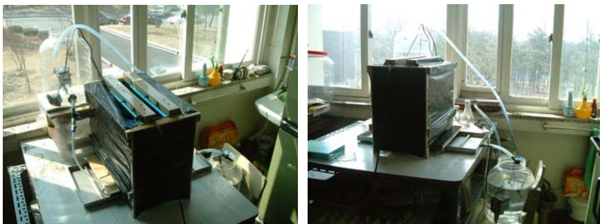
그림 7 인공광 이용 가시광 응답형 광축매반응 요인시험장치
