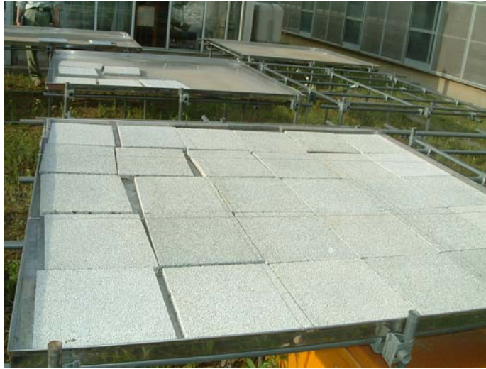
그림 16 일본 카나가와현 농업기술센터에서 시도한 광촉매에 의한 배양액 살균 시스템
