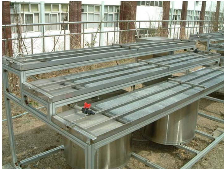
그림 19 공기중 노출에 의한 광촉매 필터 성능 변화 시험
