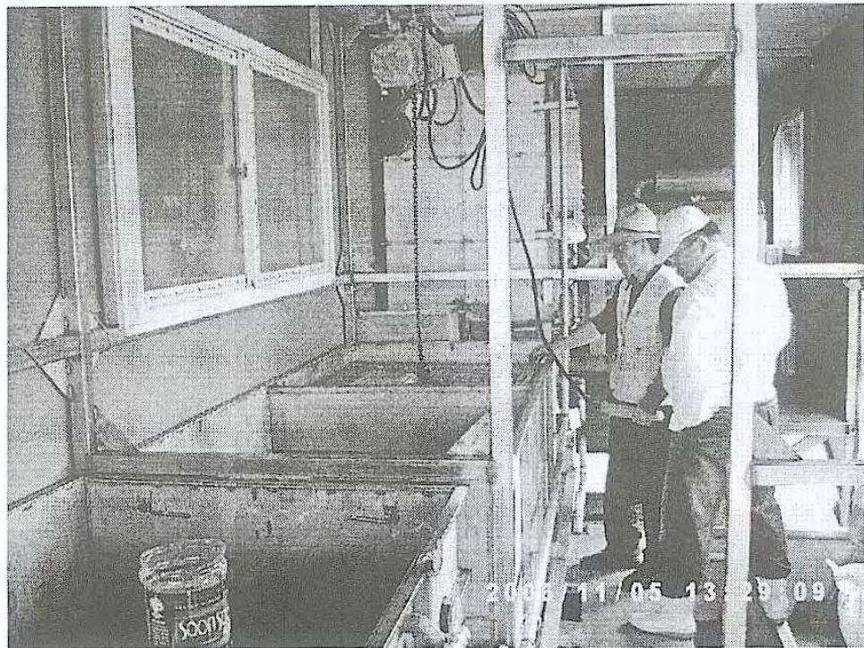
<사진 14> 이동식 배추절임장치의 배추절임 조작
