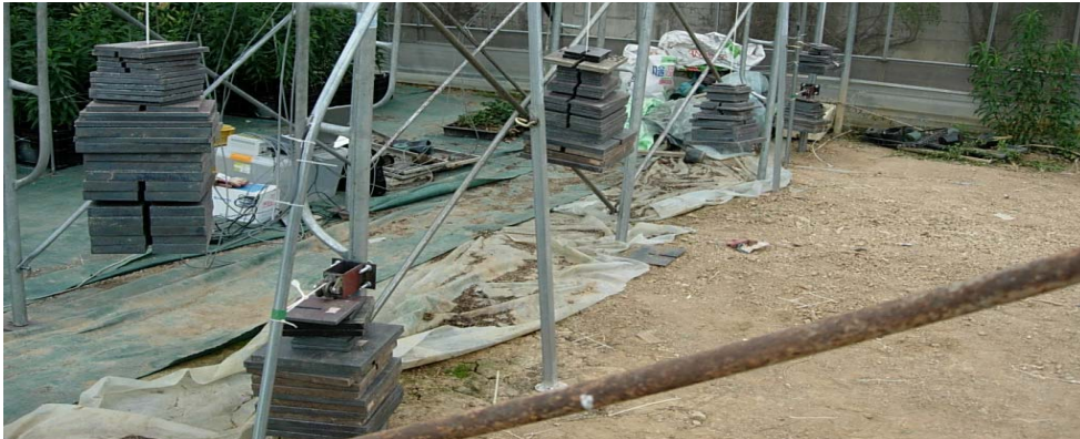
그림 124. 모의 최대풍하중(풍상측 178kgf) 재하 모습
